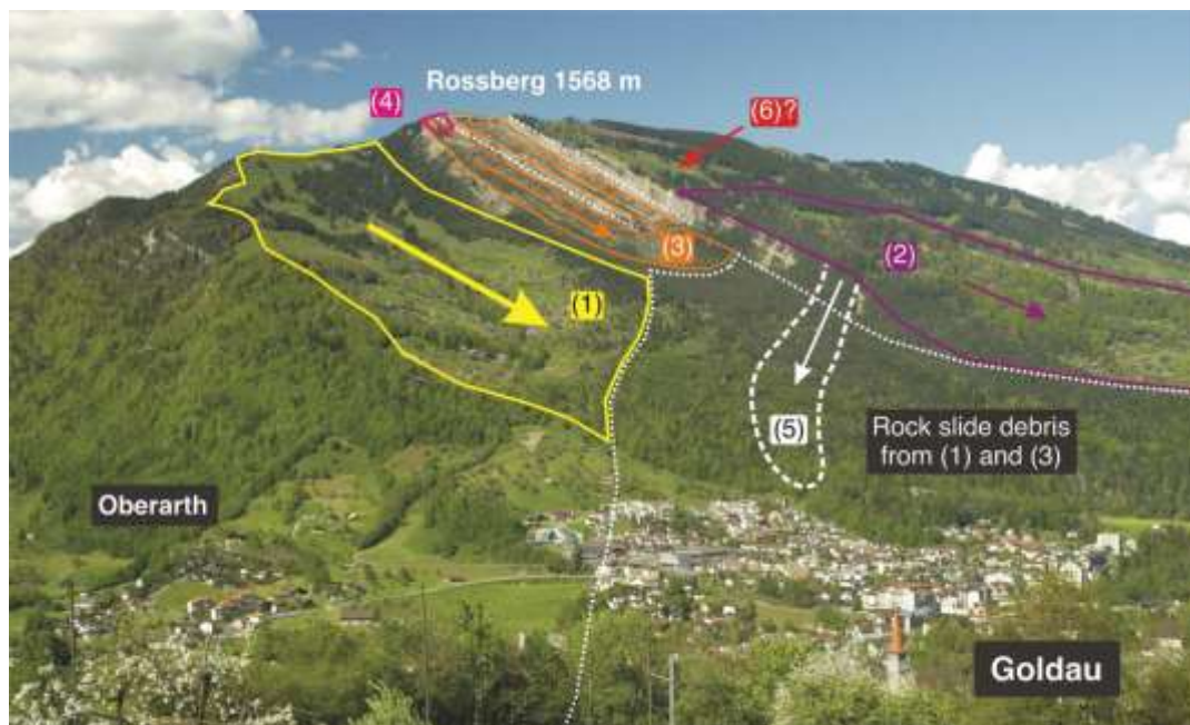
Figura 93 - Série escalonada de planos deslizantes em Rossberg
