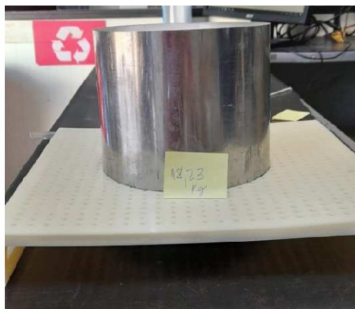
Figura 56 – Aplicação de uma carga de 18,23 kg no tampo da mesa impresso
