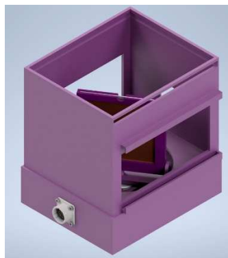
Figura 48 – Sistema de rotação encaixado na caixa recoberta em fita de chumbo para blindar o espalhamento de raios X
