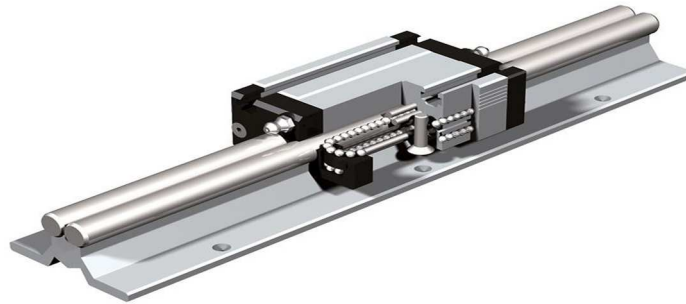
Figura 8 – Exemplo de guia de elementos rolantes, com corte de seção demonstrando a carreira de esferas
