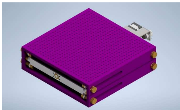
Figura 50 – Conceito final para a mesa elevatória fechada
