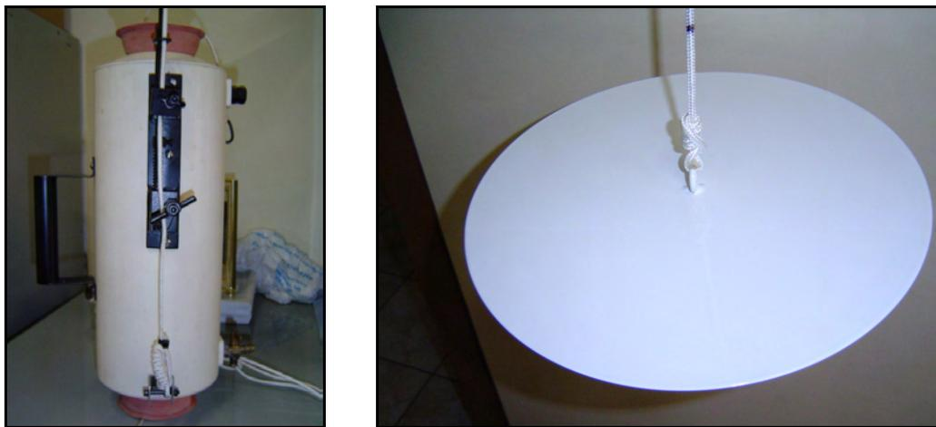
**Figura 6:** Garrafa de Van Dorn de 5 litros e Disco de Secchi
