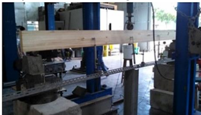
Figura 51 - Arranjo do teste de flexão das vigas de madeira lamelada colada.
