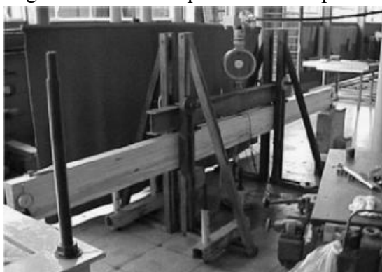
Figura 43 - Teste experimental a 4 pontos.
