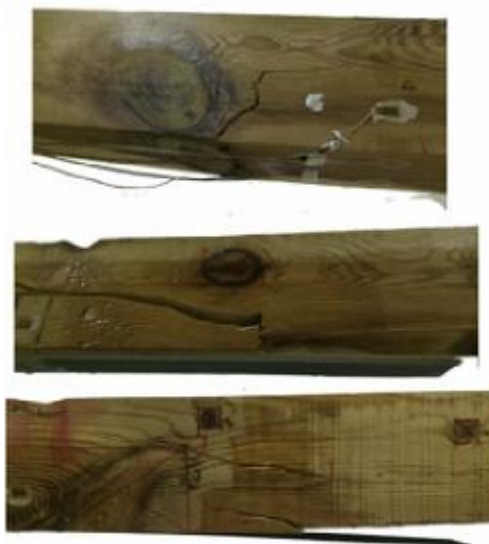
Figura 45 - Vigas com defeitos após o teste de flexão.
