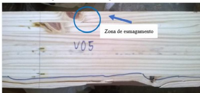
Figura 63 - Falha viga RGlulam2-2.
