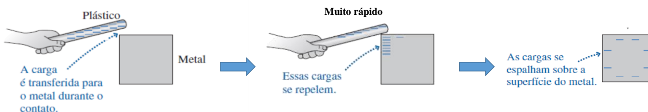
Figura 8 - Um condutor é carregado por contato com um bastão de plástico eletrizado
