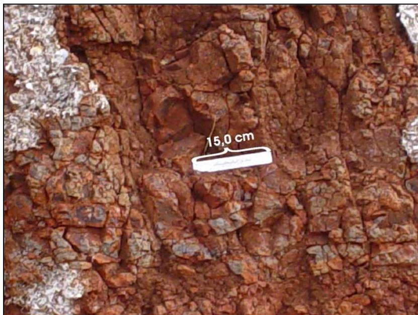
Figura 7 – Detalhe do afloramento de basalto alterado (acebolamento) de coloração ocre amarelada e intensamente fraturado (saprolito) na rodovia que liga os municípios de Londrina e Ibiporã.
