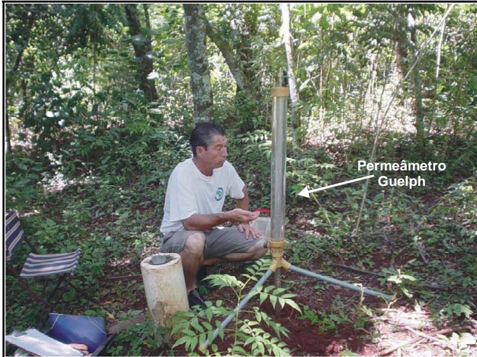
Figura 6 - Realização do ensaio de infiltração *in situ* utilizando o Permeômetro Guelph.
