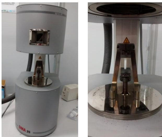
Figura 4.13 - Equipamento de DMA e a fixação da amostra.
