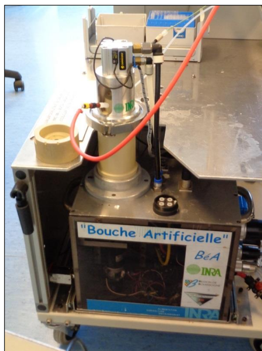
Figura 2. Simulador de mastigação ( Bouche Artificielle ).
