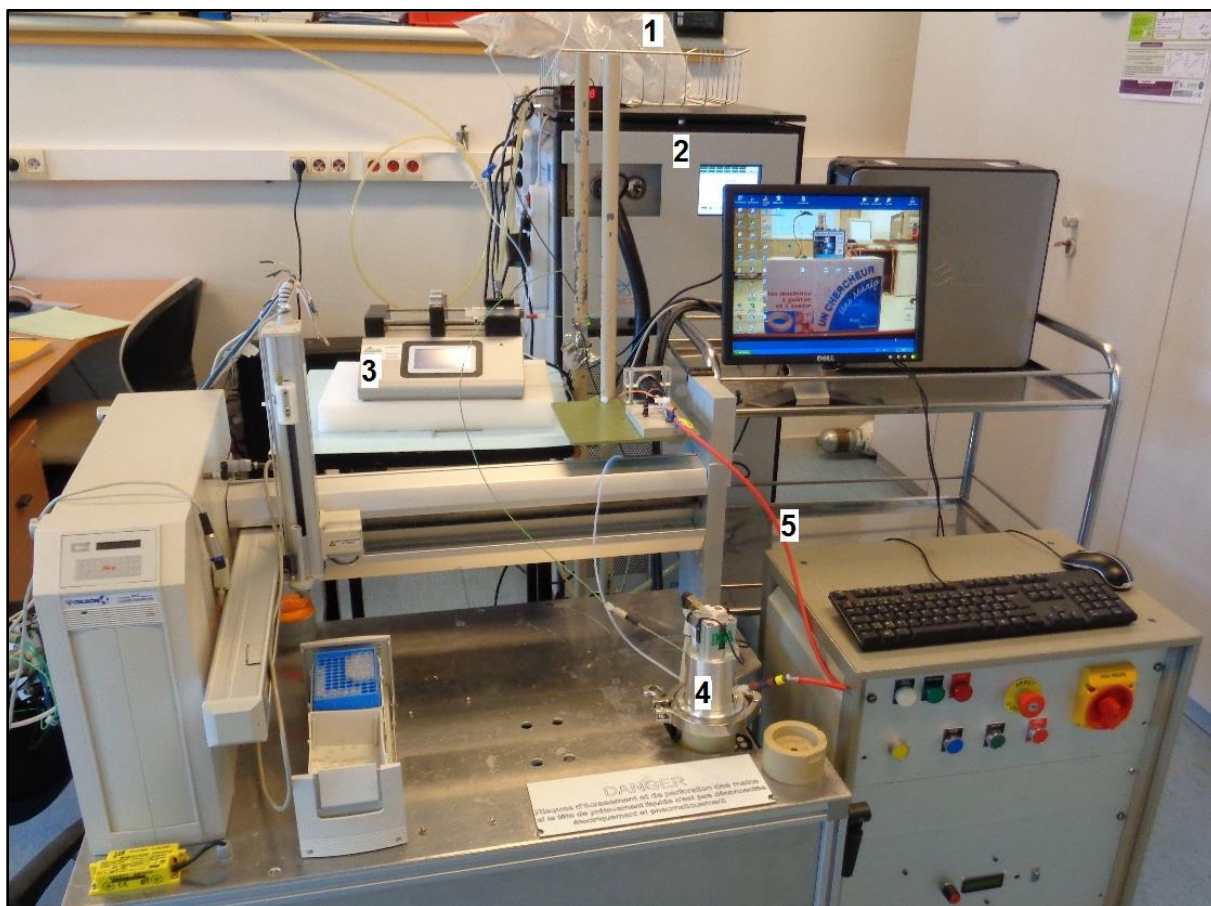
Figura 3. Simulador de mastigação acoplado ao PTR-ToF-MS (1: sacos contendo ar úmido; 2: PTR-ToF-MS; 3: controlador do fluxo de artificial saliva; 4: simulador de mastigação; 5: linha de transferência do simulador de mastigação ao PTR-ToF-MS).
