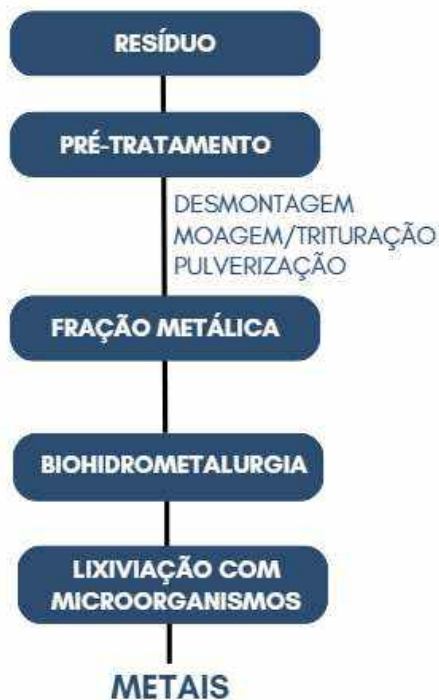
Figura 2 - Processos da biohidrometalurgia para recuperação de metais.
