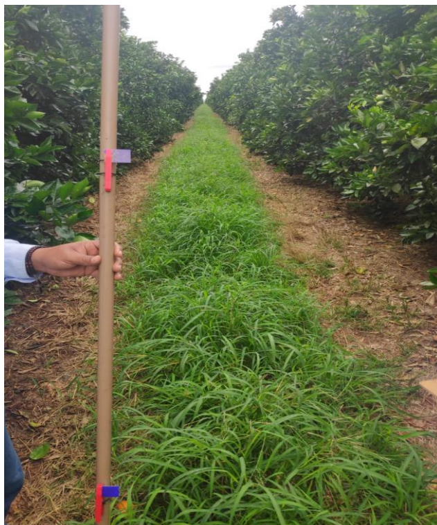
Figura 2 – Suporte em PVC (2 metros) utilizado para posicionamento dos papéis hidrossensíveis no interior das plantas de laranja, a fim de se obter a cobertura dos volumes aplicados nos tratamentos (100 e 200 mL.m -3 ).
