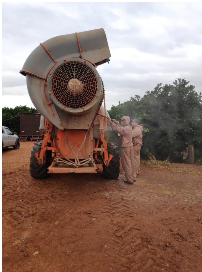
Figura 3 – Turbopulverizador Arbus4000, unilateral. Calibração para pulverização.
