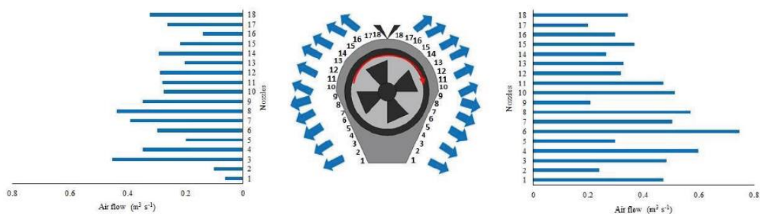
Figura 11 - Perfil de distribuição do ar dos bicos hidráulicos de ambos os lados de um pulverizador de leque axial. Souza Júnior et al. (2016)
