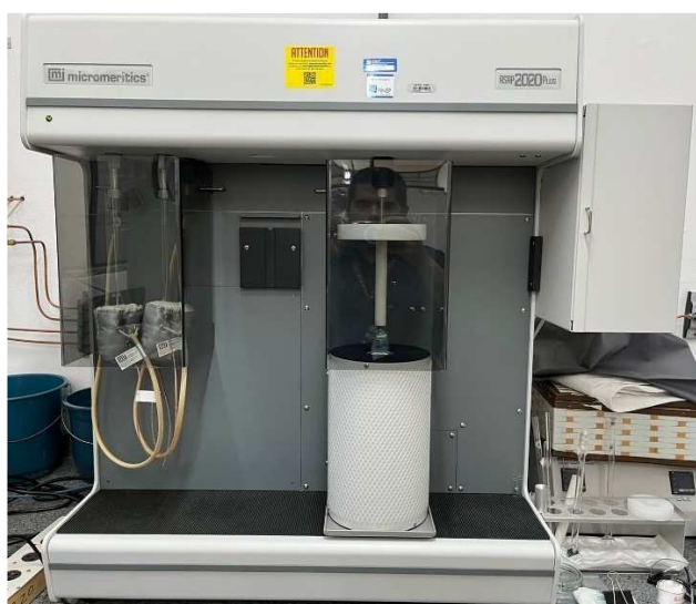
Figura 32 – Analisador de Área Superficial e Porosidade – análise pelo método BET
