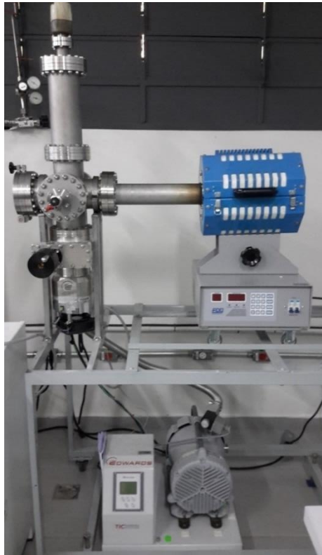
Figura 10 - Sistema de tratamento térmico com um tubo de aço inoxidável, forno e bomba à vácuo.
