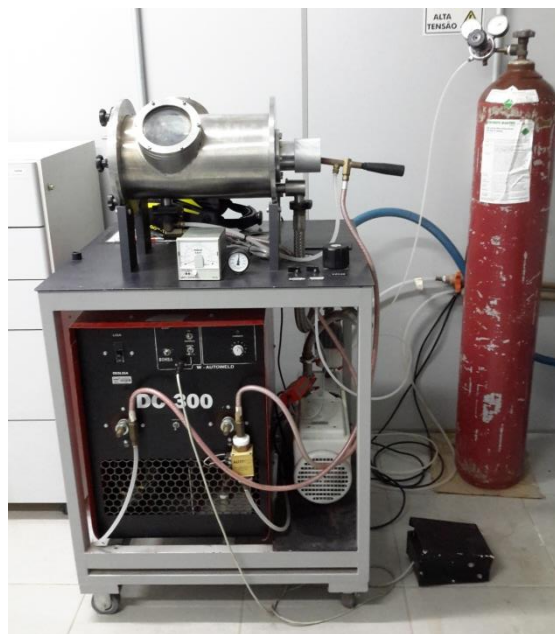
Figura 7 - Forno de fusão a arco voltaico (câmara de fusão, máquina de solda, bomba à vácuo e cilindro de argônio).
