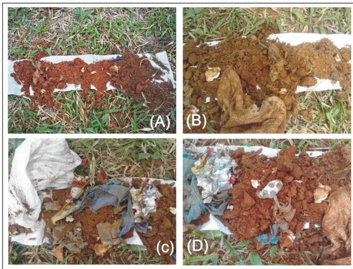
Figura 39 - Principais resíduos e materiais encontrados na sondagem no ponto PT-01.
