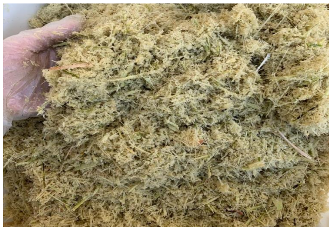
Figura 10 – Colmos de cana comercial RB975201 desintegrados após processamento em picador-desintegrador de facas oscilantes. (Fonte: De autoria própria)
