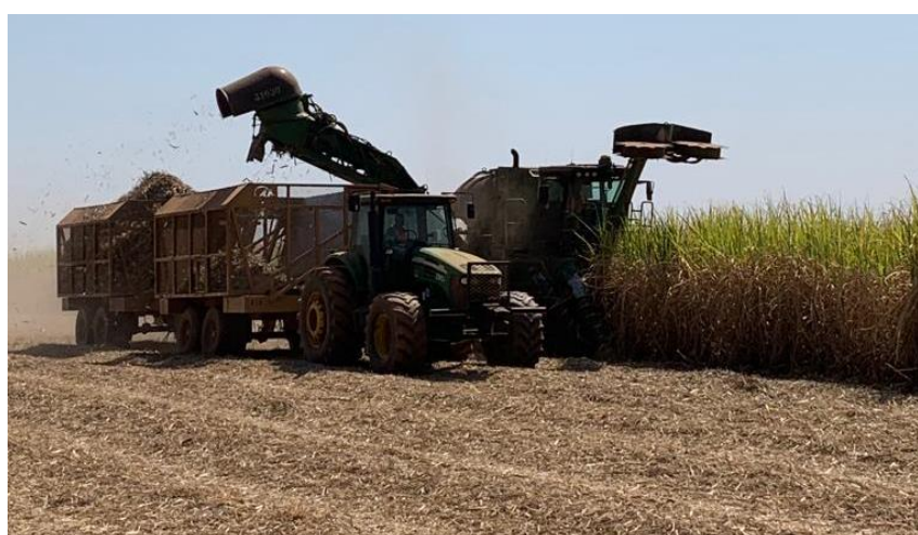
Figura 04 - Colheita mecanizada na região de Araçatuba/SP com despontador desligado: aumento de palmito na matéria-prima. (Fonte: De autoria própria).
