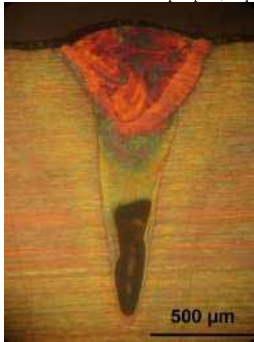
Figura 33- Micrografia cordão de solda 5. Microscopia óptica, ataque Behara modificado.
