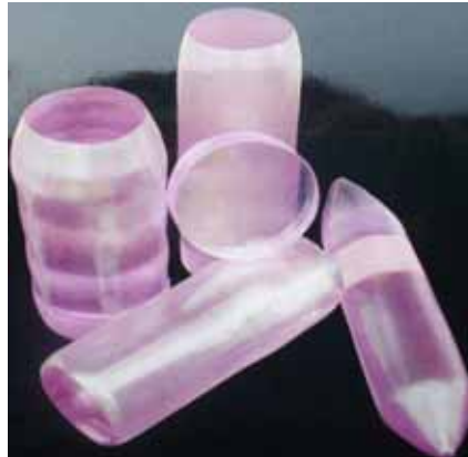
Figura 5- Cristais de Nd:YAG utilizados em lasers de estado sólido.
