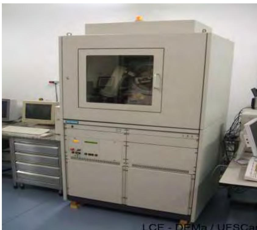
Figura 11- Difratorômetro de raios X.
