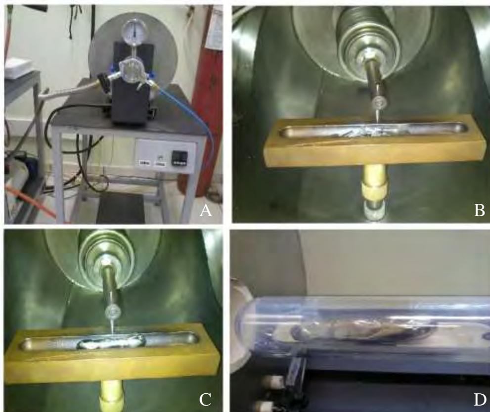
Figura 6 – Sequência empregada para a fusão da liga: a) forno para fusão da liga b) colocação dos materiais no cadinho para fundição c) obtenção do lingote d) amostra após encapsulamento.
