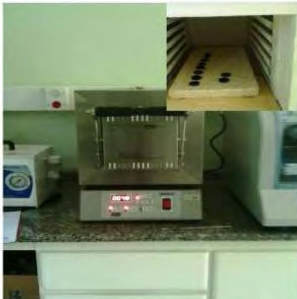
Figura 7 - Forno tipo mufla utilizado para o tratamento térmico das amostras após tratamento alcalino. Destaque para amostras dentro do forno.
