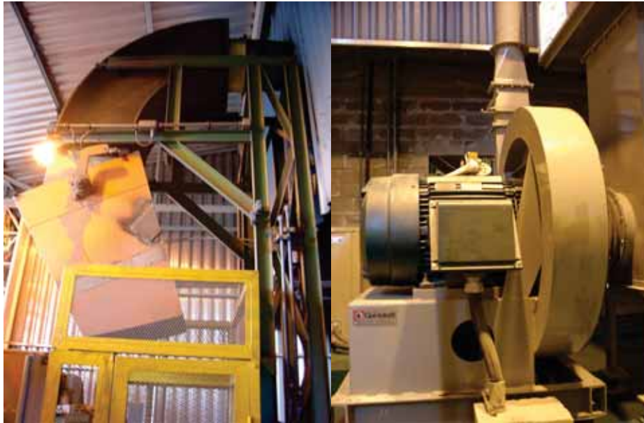
Figura 6.2 - Separador ar/material (esquerda) e motor de sucção (dir)
