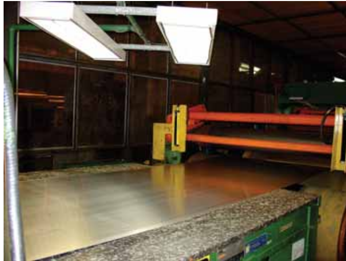
Figura 5.10 - Mesa de inspeção da PC.
