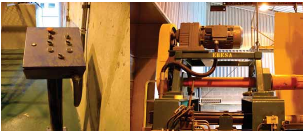
Figura 6.4 - Controlador do enrolador de refíles (esq) e motor de acionamento (dir)
