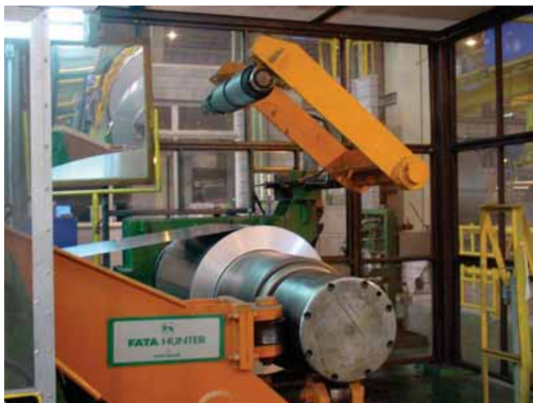
Figura 5.4 - Carretel de descarga com braço hidráulico.
