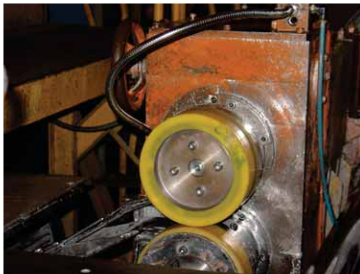
Figura 5.7 - Cortador lateral (detalhe das facas rotativas) e guia do refile.
