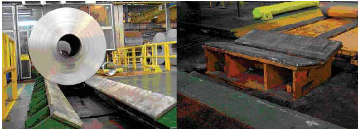
Figura 5.3 - Magazine de entrada e Carro de bobina de entrada.
