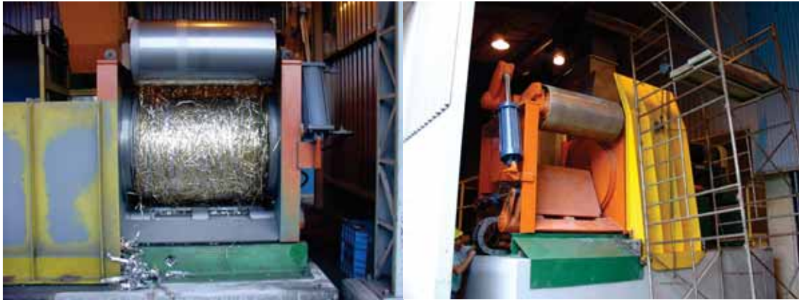
Figura 6.3 - Exemplo de enrolador de refíles em funcionamento (esq) e instalação do enrolador de refíles da PC (dir)
