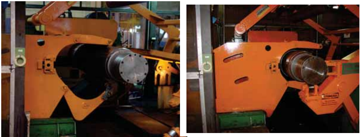
Figura 5.12 - Detalhe do Belt Wrapper “abraçando” o cilindro.
