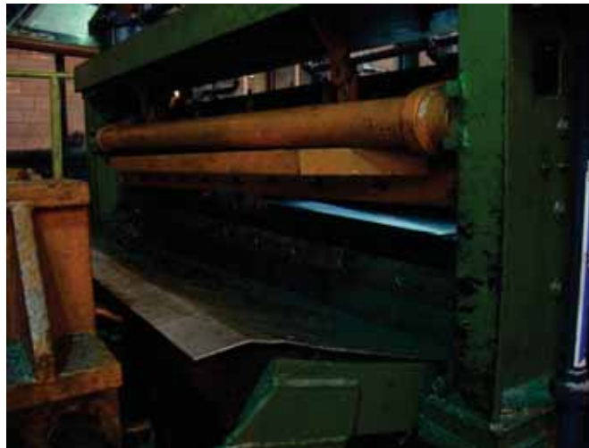
Figura 5.5 - Cortador de entrada e início da mesa guia.
