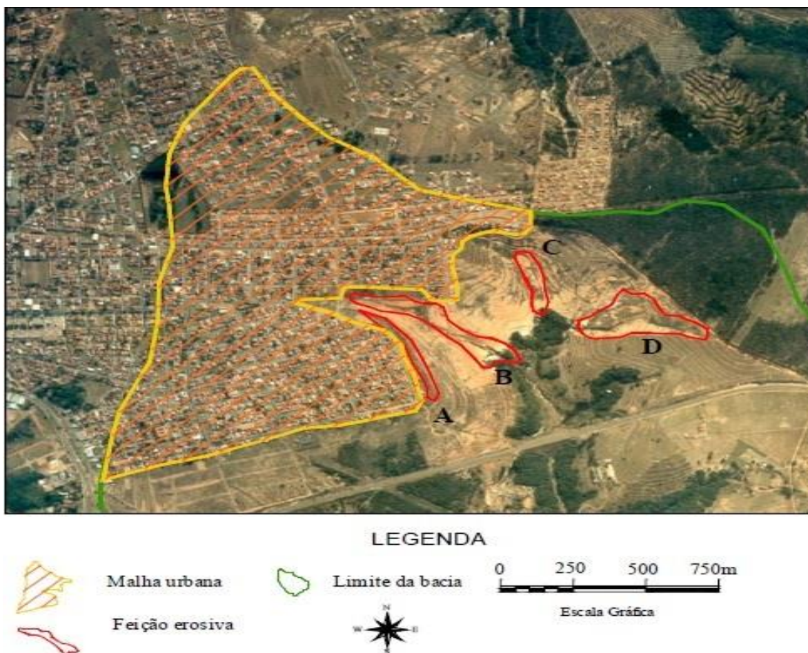
Figura 11: Feições erosivas na área de estudo
