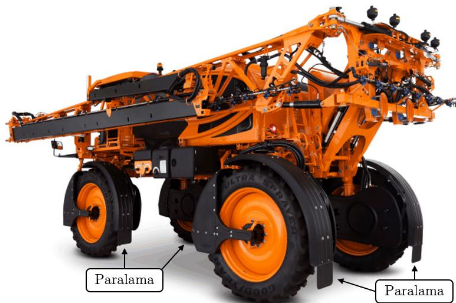
Figura 48 – Foto do pulverizador automotriz Jacto Uniport 4530 com barra de pulverização de 42 metros. Máquina em que foi montado a estrutura do paralama durante ensaio de durabilidade.
