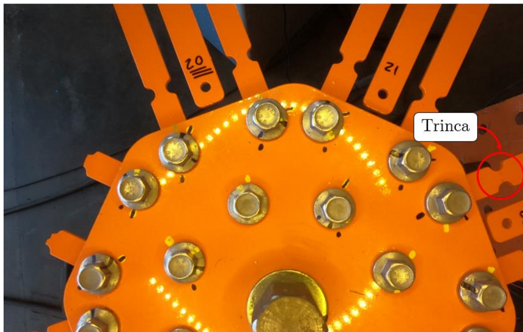
Figura 24 – Exemplo de falha identificada por foto tirada de uma das câmeras de controle do ensaio de durabilidade em bancada.
