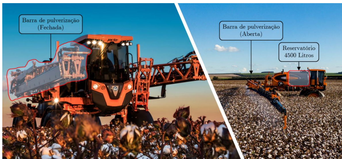
Figura 46 – Foto do pulverizador automotriz Jacto Uniport 4530 com reservatório de 4500 litros e barra de pulverização 42 metros, nas condições fechada e aberta.
