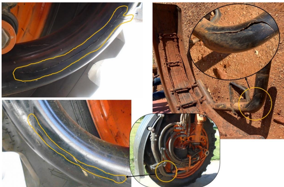
Figura 47 – Fotos de falhas no tubo principal do paralama durante ensaio de pista de provas e durante trabalho em campo.
