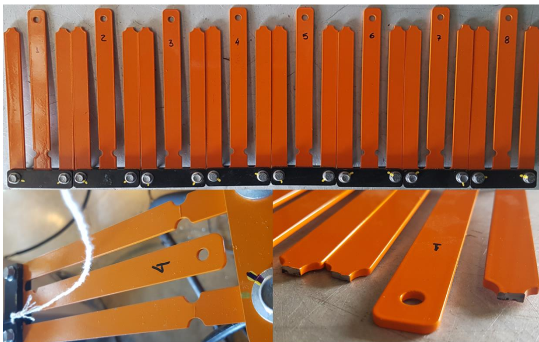
Figura 25 – Modo de falha dos oito corpos de prova do primeiro ciclo do ensaio de durabilidade.
