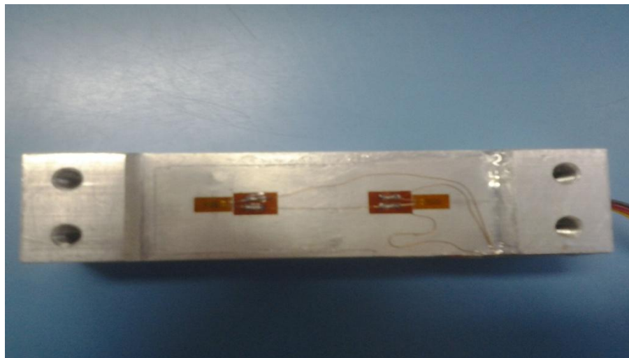
Figura 23- Indicação da posição dos extensômetros na célula
