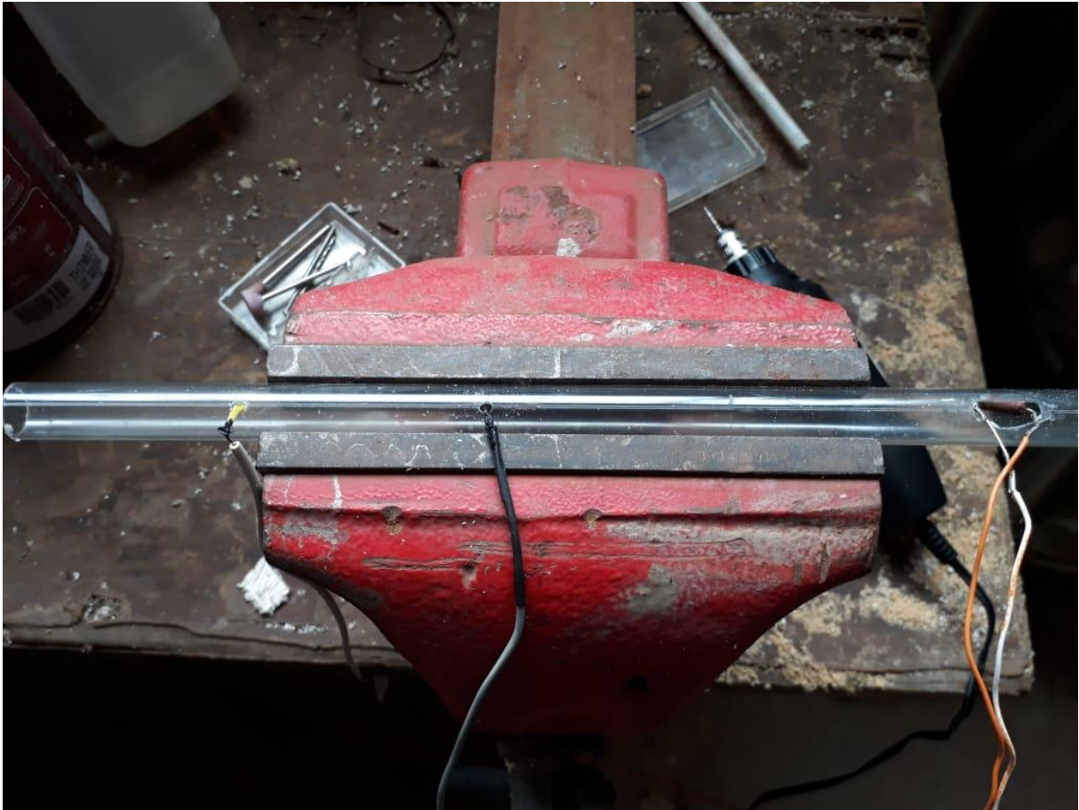
Figura 26 - Posicionamento das sondas térmicas para realização do teste do pré-protótipo
