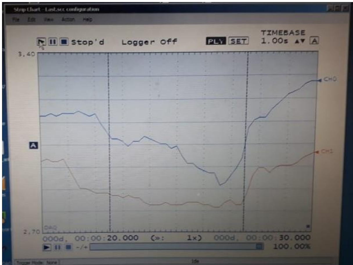
Figura 30 - Leitura da resistência das sondas térmicas NTC do primeiro protótipo efetuada com o software TracerDAQ
