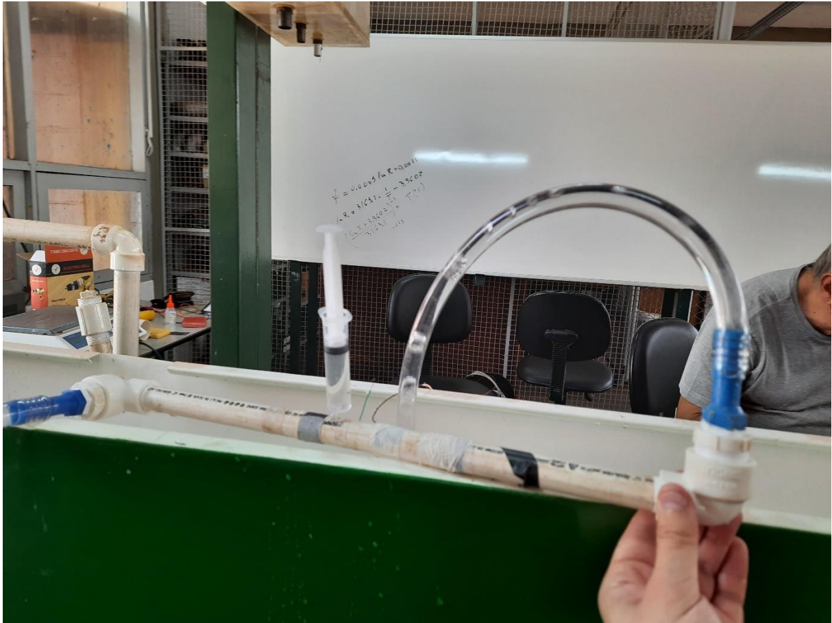
Figura 37 – Injeção de água previamente aquecida utilizando seringa hipodérmica
