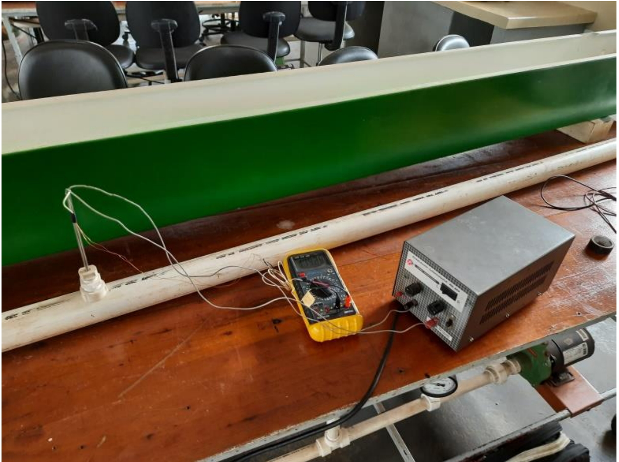
Figura 42 - Testagem da sonda convectiva
