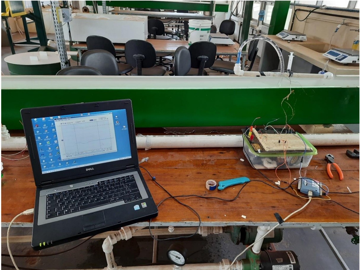
Figura 36 – Testagem da sonda de advecção de traçador térmico previamente aquecido
