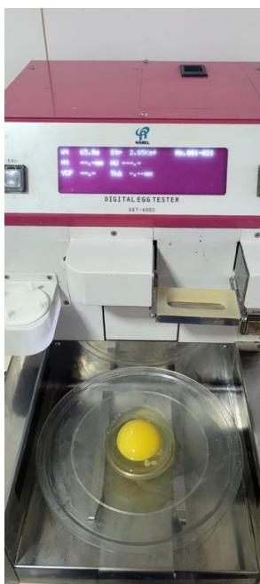
Figura 7 - Análise de qualidade na máquina Digital Egg Tester
