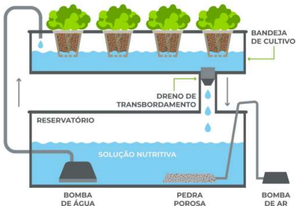
Figura 2 - Sistema de Fluxo Laminar de Nutrientes (NFT)
