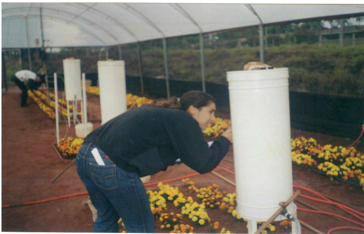
Figura 8. Monitoramento do consumo de água através da leitura na bureta do tanque medidor em ambiente protegido.
