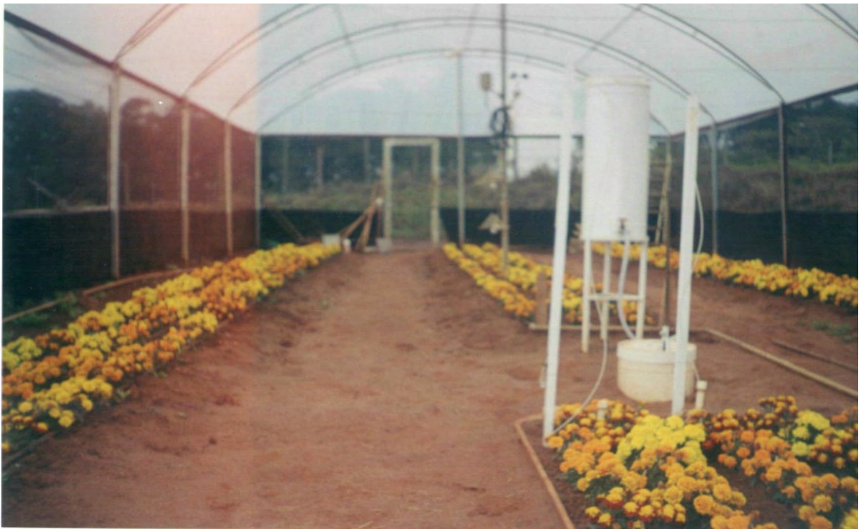
Figura 7. Detalhe do lisímetro em ambiente protegido.
