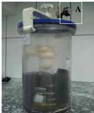
Figura 2: Jarra de anaerobiose. A – Detalhe da válvula de controle para retirada dos gases através de vácuo e introdução das misturas gasosas.
