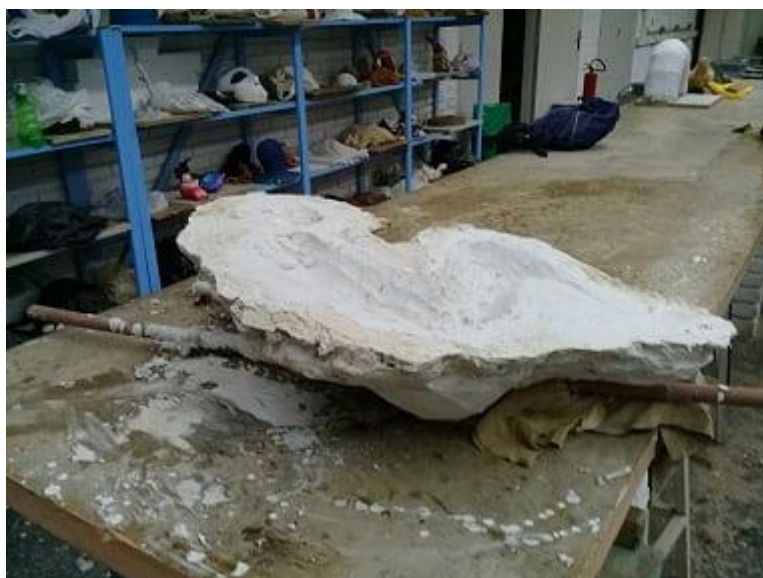
Figura 83 – Molde já preenchido com gesso, fotografia de Lívia Ranzoti, 2019.
