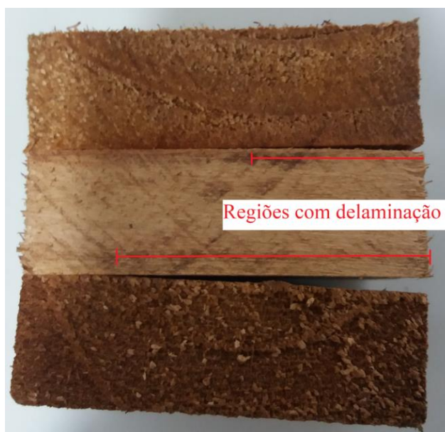
Figura 42 – Corpo de prova após o ensaio de delaminação.
