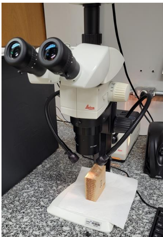
Figura 49 – Análise de microscopia ótica das linhas de cola em corpo de prova de dimensões 80 mm x 80 mm x 50 mm.
