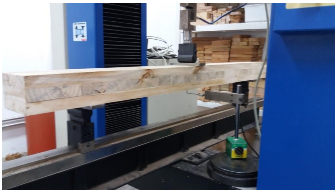
Figura 50 – Detalhe do corpo de prova de flexão por vão variável durante o ensaio.
