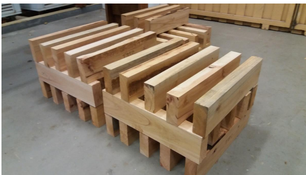
Figura 36 – Lamelas de madeira entabicadas para secagem natural.
