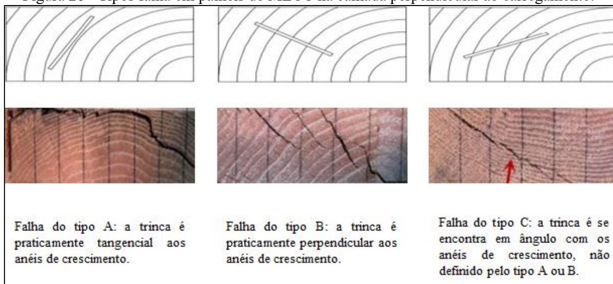
Figura 20 - Tipos falha em painéis de MLCC na camada perpendicular ao carregamento.
