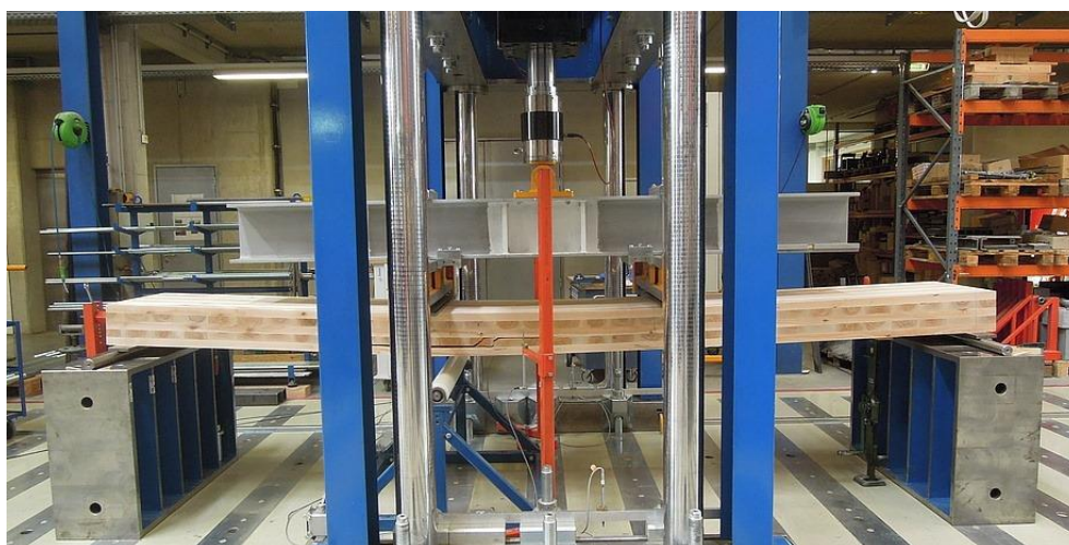
Figura 25 - Ensaio de flexão realizado em painel de MLCC.
