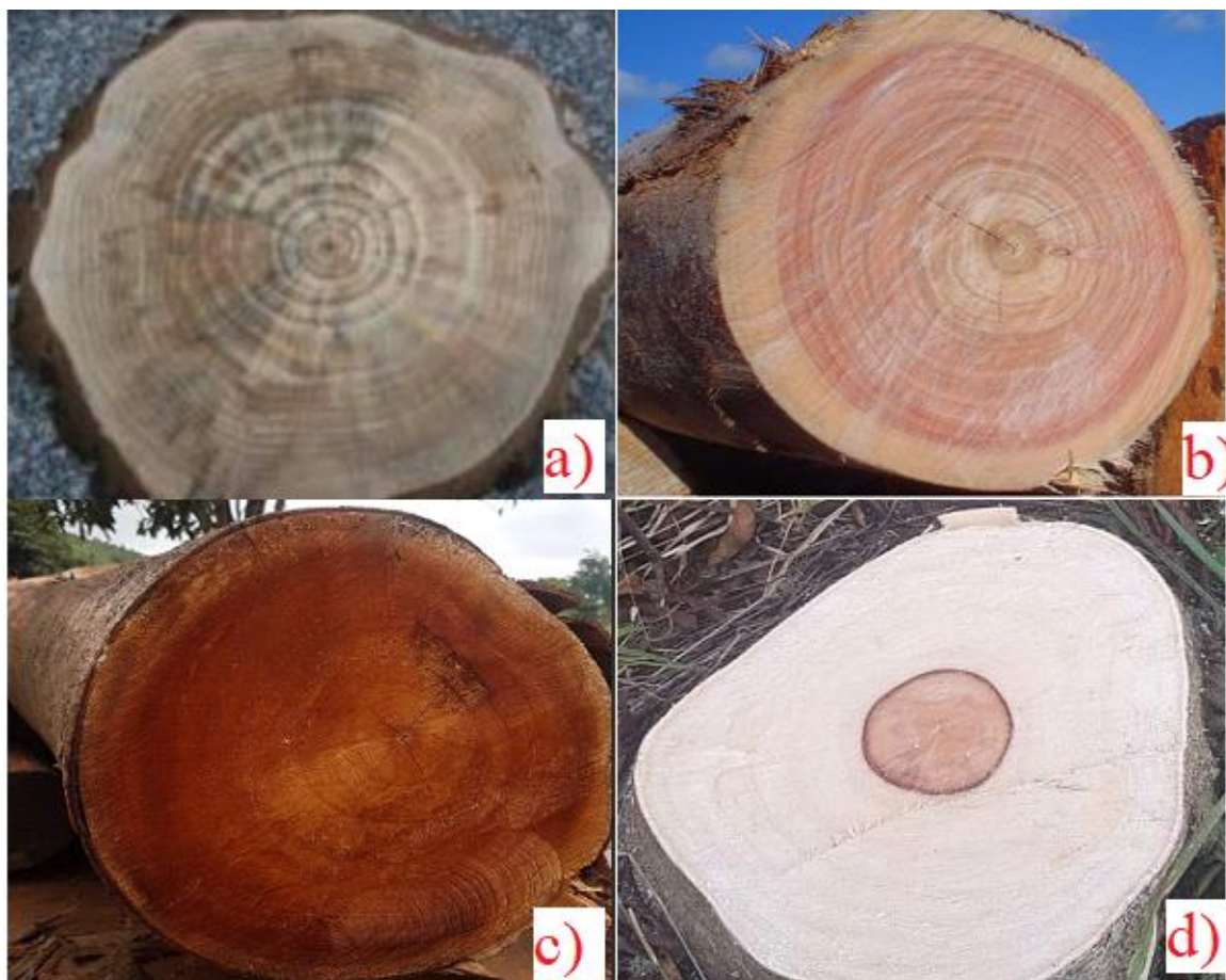
Figura 11 – Madeira proveniente das espécies de: a) Pinus elliottii ; b) Eucalyptus grandis ; c) Toona ciliata ; e d) Acrocarpus fraxinifolius .
