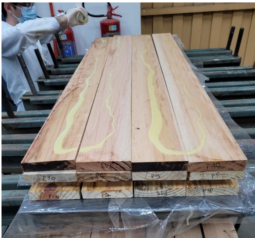
Figura 37 – Aplicação de adesivo nas lamelas durante a produção do MLCC.
