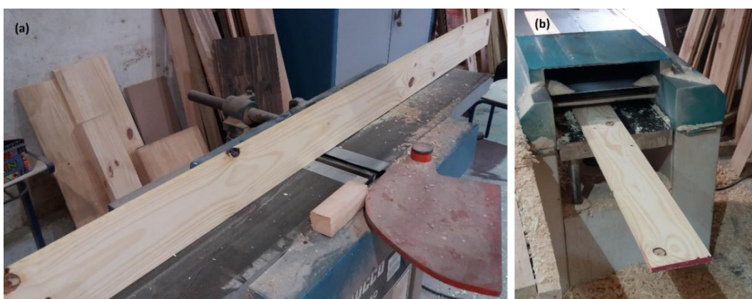
Figura 34 – Aplainamento das tábuas: (a) Desempenadeira; (b) Desengrossadeira.
