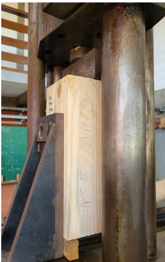
Figura 53 – Carregamento das amostras de cisalhamento vertical até a ruptura realizadas no LaMEM/EESC/USP.
