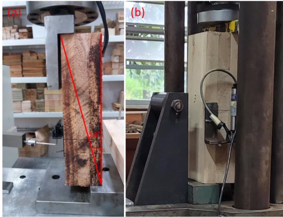
Figura 52 – Determinação experimental da rigidez ao rolling shear ( G_{vt} ) por cisalhamento vertical utilizando: (a) apenas da lamela externa; (b) deslocamento relativo das lamelas externas com transdutores LVDT em ambos os lados do corpo de prova.
