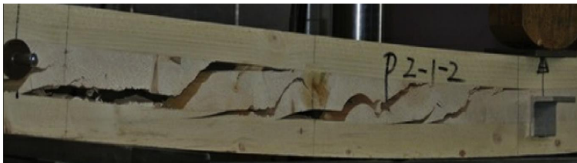
Figura 19 - Falha por rolling shear em um corpo de prova de MLCC submetido à flexão.
