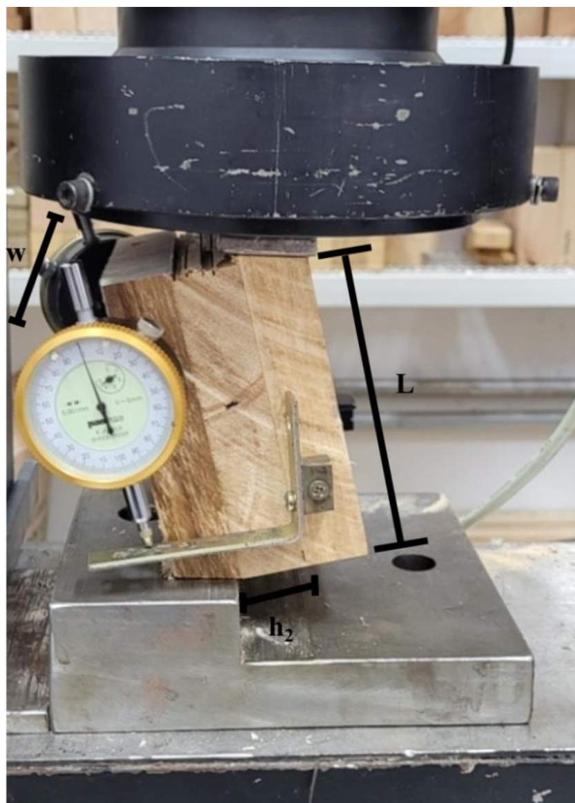
Figura 55 – Carregamento da amostra de cisalhamento inclinado sem as pernas alongadas durante o ensaio para determinação da rigidez ao rolling shear .
