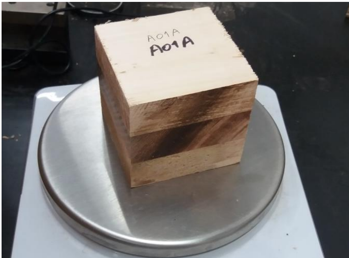
Figura 40 – Corpo de prova para os ensaios de delaminação e de cisalhamento das linhas de cola.
