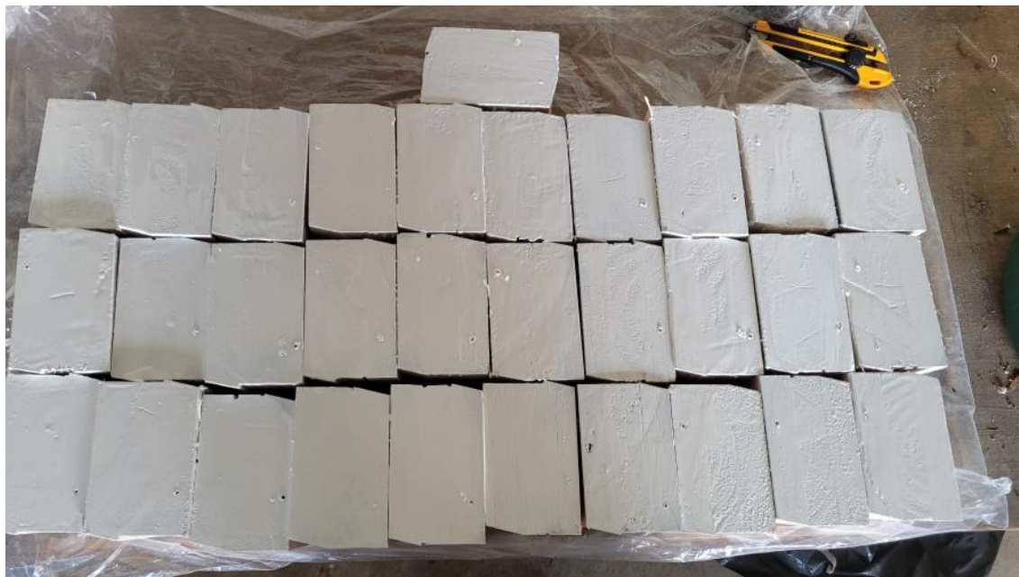
Figura 56 – Corpos de prova de cisalhamento inclinado após a pintura de uma das faces (superfícies laterais).
