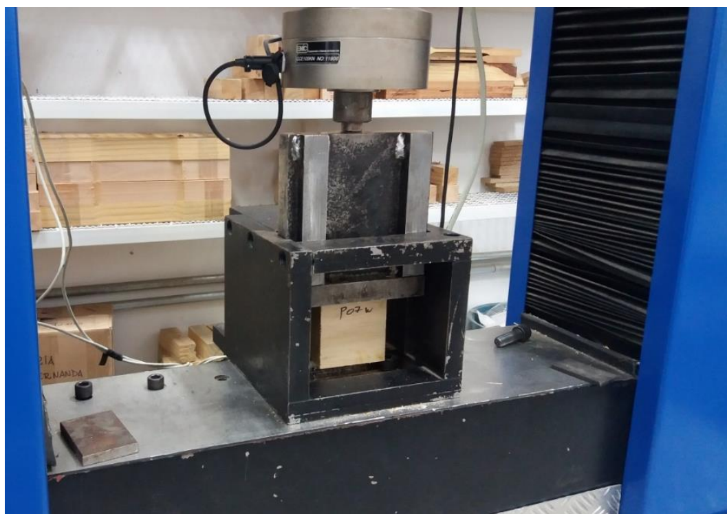
Figura 43 – Arranjo do ensaio de cisalhamento na linha de cola em dispositivo metálico acoplado à máquina universal de ensaios EMIC.
