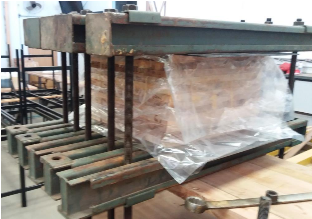
Figura 38 – Prensagem de quatro placas de MLCC simultaneamente para os ensaios preliminares.
