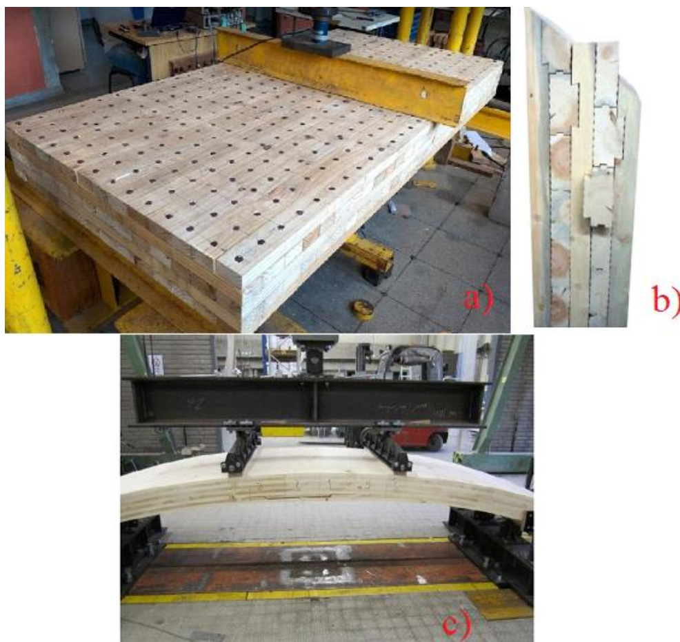
Figura 8 – Classes de MLCC em fase de desenvolvimento: a) MLCC com cavilhas; b) MLCC unido por encaixes sem adesivo; e c) MLCC curvo.
