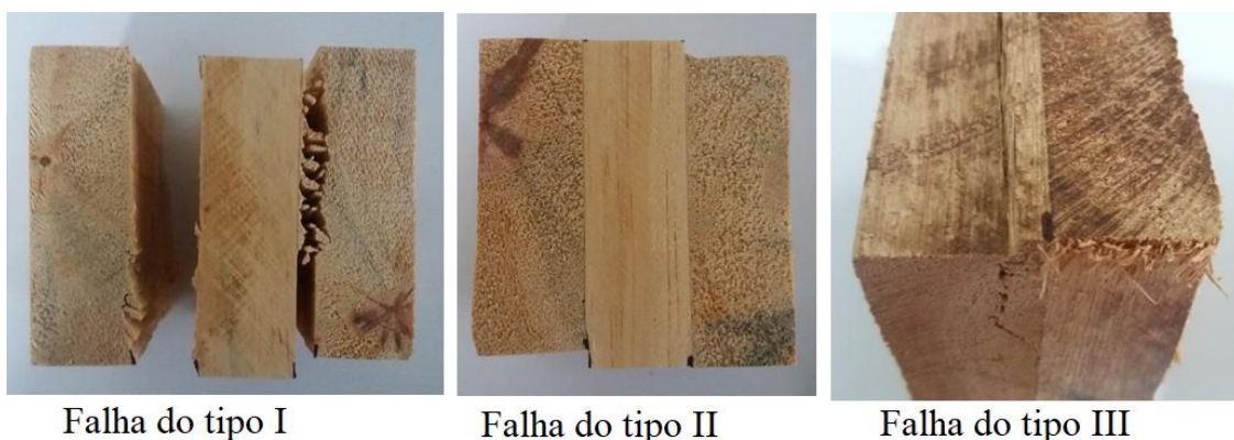
Figura 44 – Tipos de falhas observadas no ensaio de cisalhamento na linha de cola.
