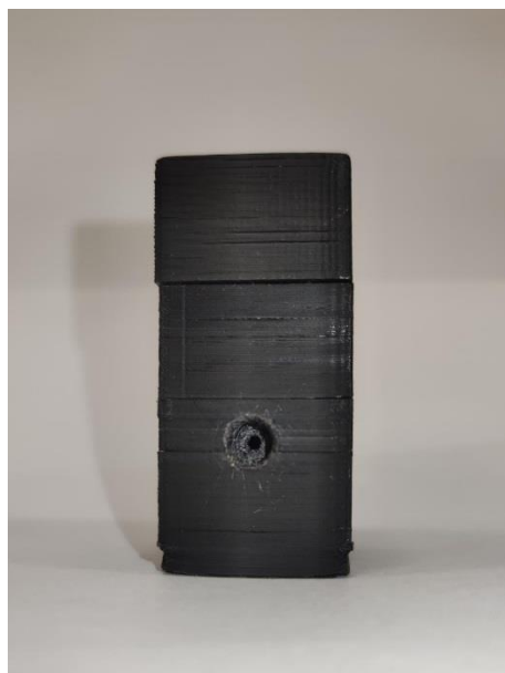
Figura 42. Novo suporte para cubeta e tampa, confeccionados em material ABS. Fonte: Elaborada pelo autor.
