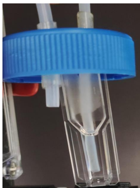
Figura 21. Disposição dos tubos de teflon no interior do tubo falcon. Fonte: Elaborada pelo autor.
