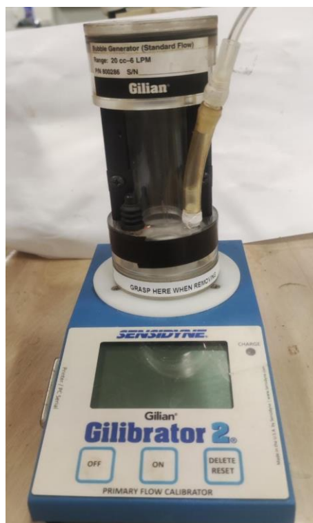
Figura 19. Gerador de bolha Gilian Gilibrator 2 Calibration System Standard Kits – Sensidyn – utilizado como medidor de vazão padronizado.
