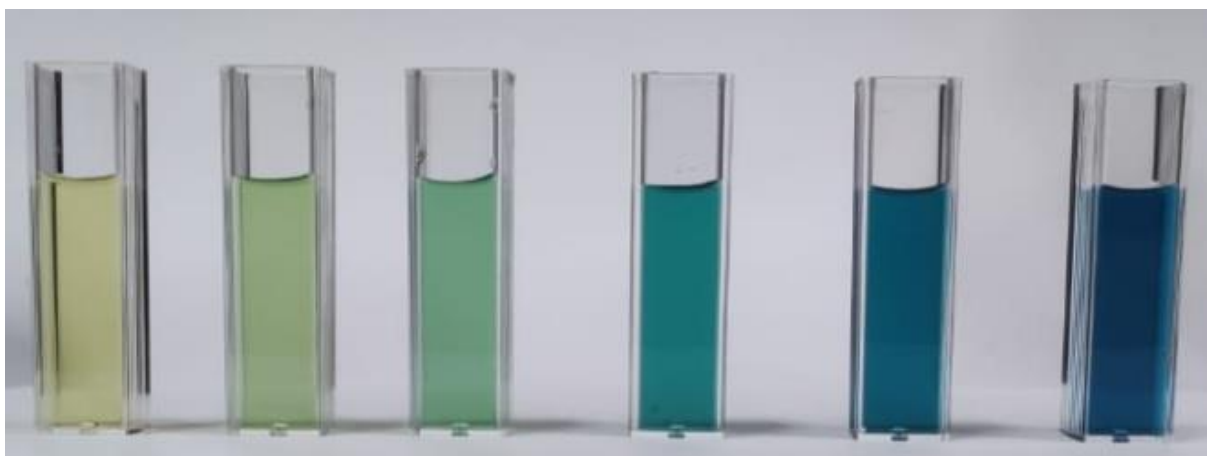
Figura 26. Soluções utilizadas para construção da curva de calibração contendo respectivamente 0, 0.05, 0.1, 0.3, 0.5, 0.7 \mu\text{g mL}^{-1} de formaldeído.
