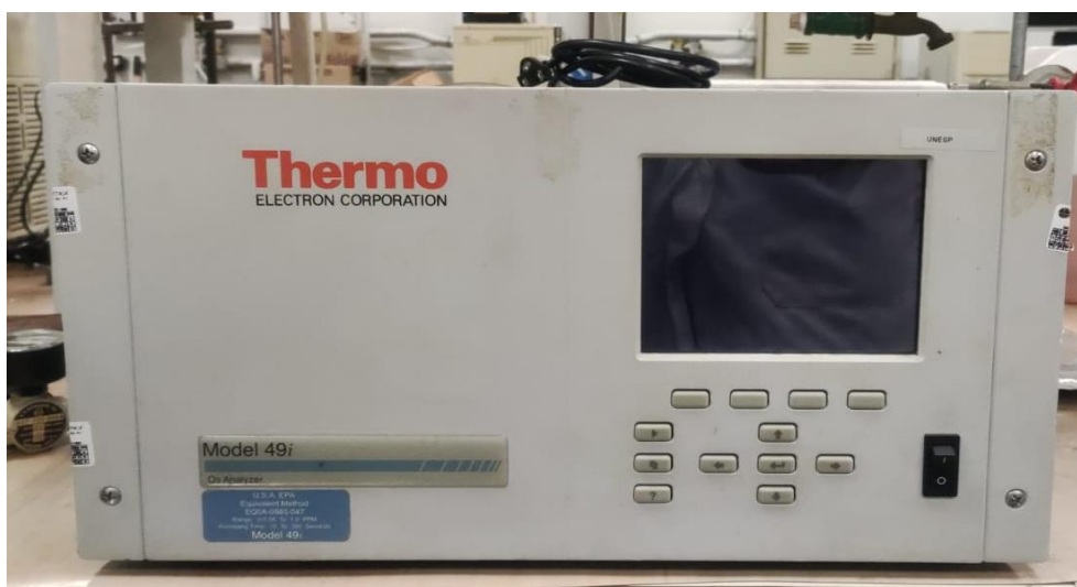
Figura 24. Analisador de O 3 da Thermo Electron Corporation – Model 49, utilizado para a quantificação de O 3 . Fonte: Elaborada pelo autor.
