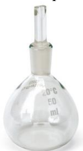
Figura 3 - Picnômetro de 50ml usado para medidas de densidade.
