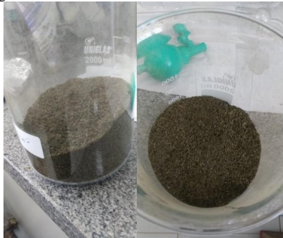
Figura 17 - Granulometria obtida com a trituração.
