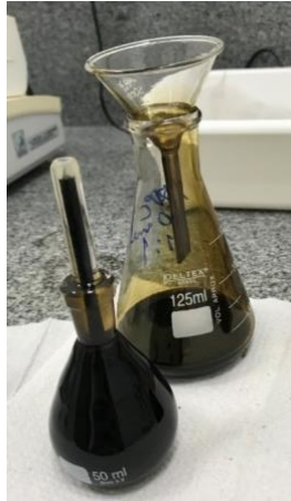
Figura 4 - Determinação da densidade do bio-óleo
