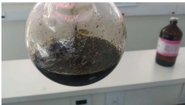
Figura 9- Liquefeito após tempo de reação.
