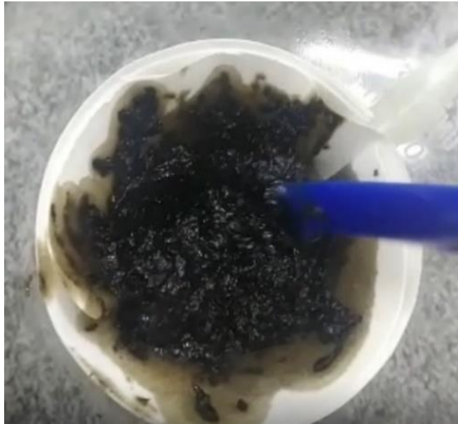
Figura 20 - Resíduo obtido no processo de liquefação.
