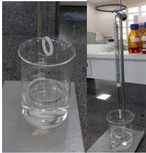
Figura 5 - Medição da tensão superficial através do método do anel.
