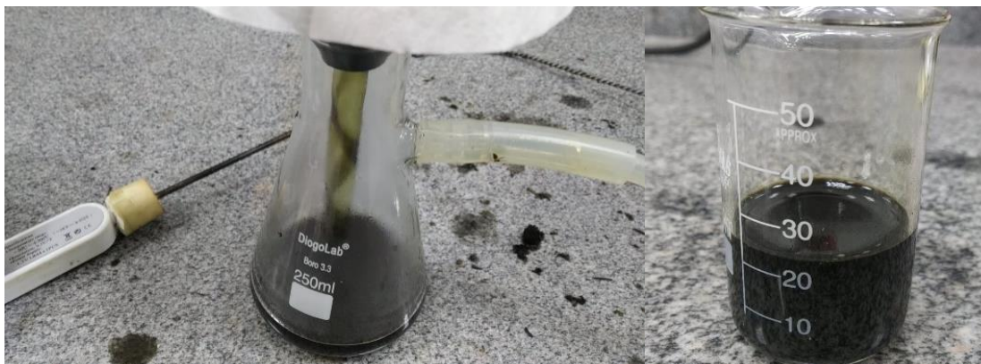
Figura 18 - Filtragem do liquefeito e liquefeito obtido.
