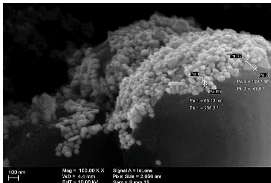
Figura 8C - Morfologias ultra estruturais das AgNPs-HEScLeaf. Obtido por FEG-SEM. Magnificação de 200.000 x.
