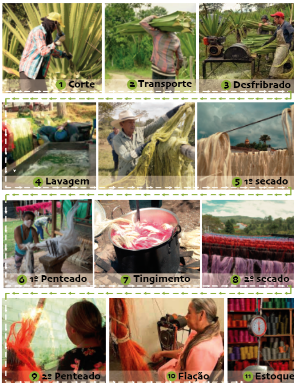
Figura 15 - Sequência produtiva do sisal até a obtenção do fio.
