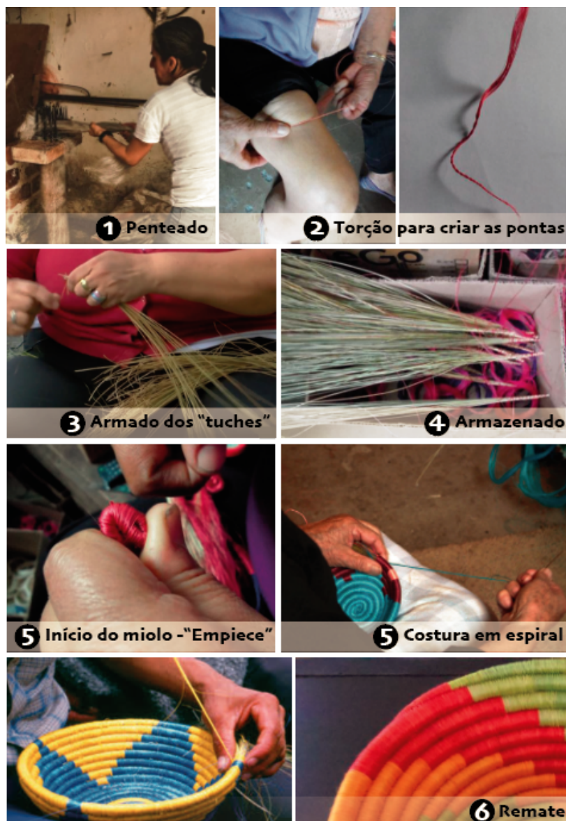
Figura 22 - Processo de fabricação cestaria em rolo.
