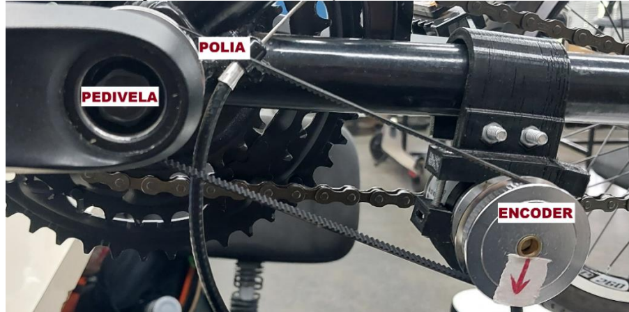
Figura 16 – Instalação do encoder no pedivela através do sistema de polia
