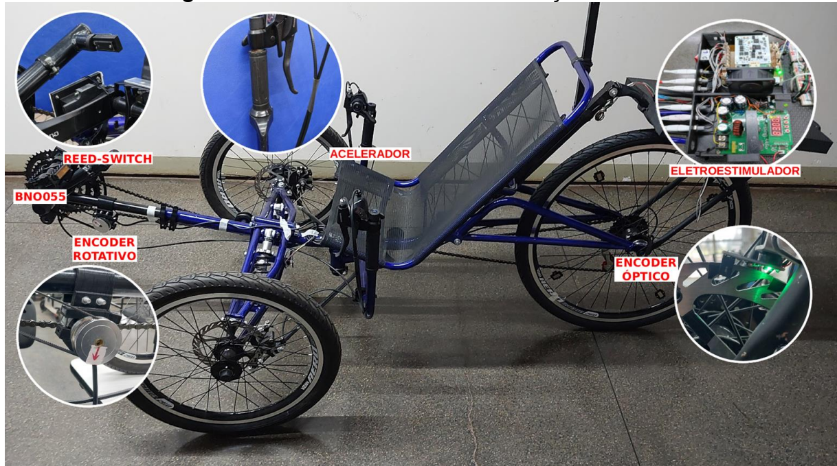
Figura 19 – Trike com toda instrumentação instalada
