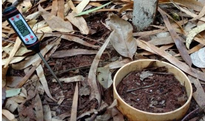
Figura 9. Termômetro medidor de temperatura do solo concomitante ao sistema LI-8100.
