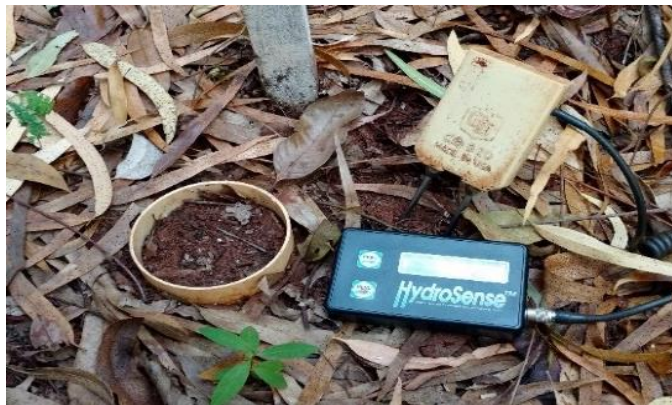
Figura 10. TDR - Hydrosense system, sistema portátil utilizado para avaliação da umidade do solo.
