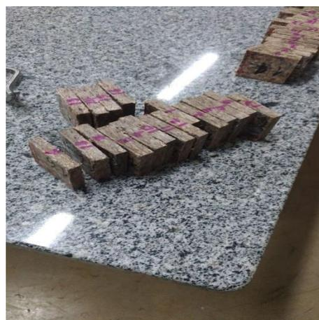
(b) Corpos de prova após secagem
