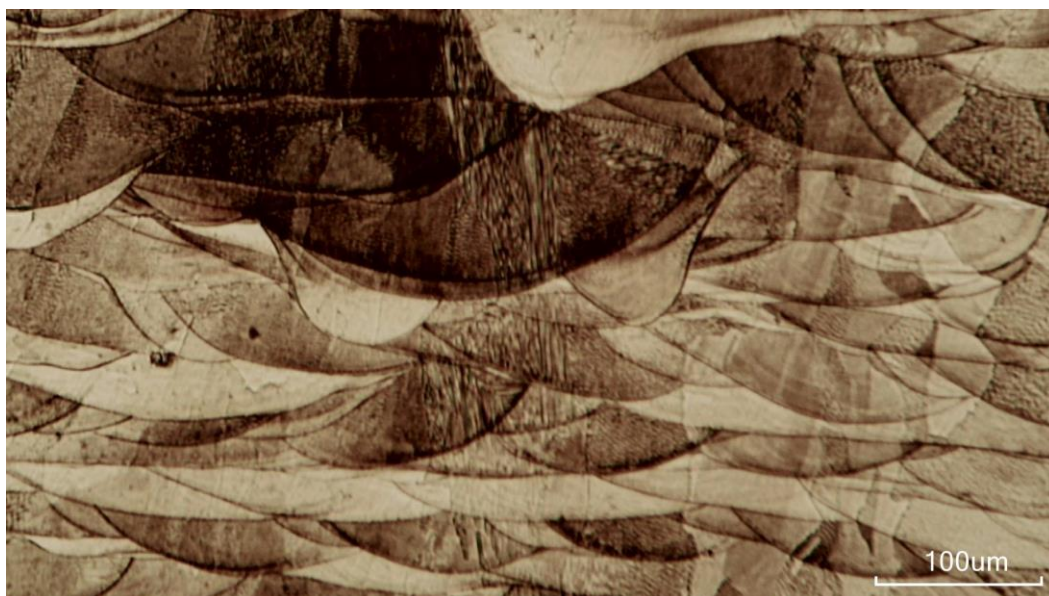
Figura 18: Microscopia óptica do aço 316 L fabricado por MA, com potência do feixe de laser de 211W, em uma escala de 100 \mu\text{m} . Fonte: Autor.
