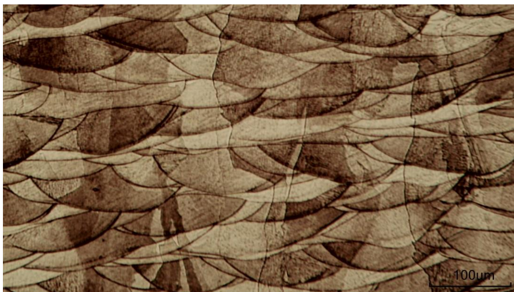
Figura 12: Microscopia óptica do aço 316 L fabricado por MA, com potência do feixe de laser de 184W, em uma escala de 100 \mu\text{m} . Fonte: Autor.
