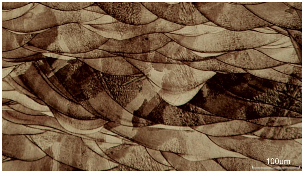
Figura 17: Microscopia óptica do aço 316 L fabricado por MA, com potência do feixe de laser de 211W, em uma escala de 100 \mu\text{m} . Fonte: Autor.
