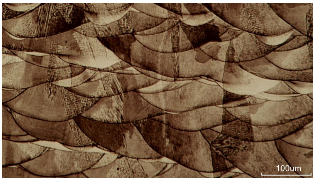
Figura 20: Microscopia óptica do aço 316 L fabricado por MA, com potência do feixe de laser de 211W, em uma escala de 100 \mu\text{m} . Fonte: Autor.
