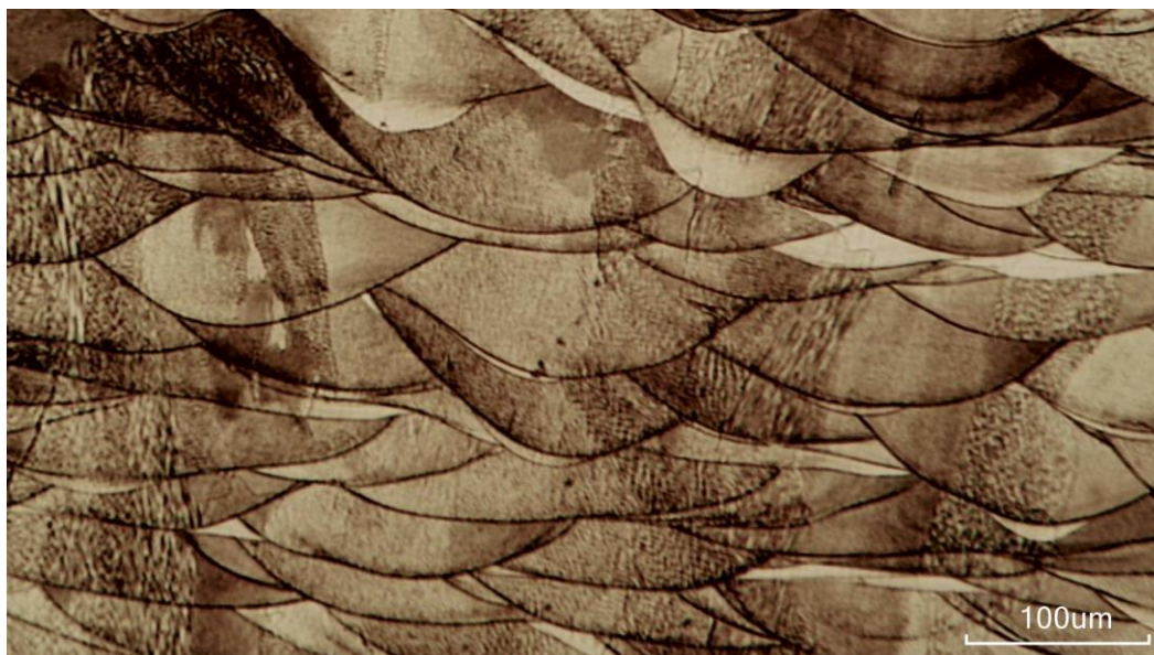
Figura 21: Microscopia óptica do aço 316 L fabricado por MA, com potência do feixe de laser de 211W, em uma escala de 100 \mu\text{m} . Fonte: Autor.
