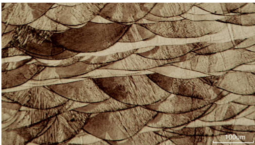
Figura 16: Microscopia óptica do aço 316 L fabricado por MA, com potência do feixe de laser de 184W, em uma escala de 100 \mu\text{m} . Fonte: Autor.
