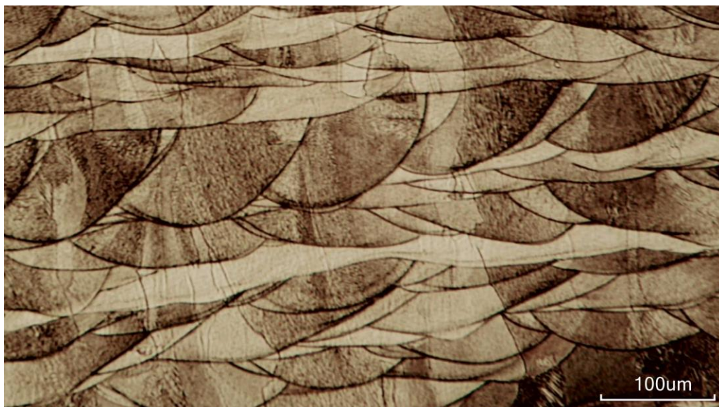
Figura 15: Microscopia óptica do aço 316 L fabricado por MA, com potência do feixe de laser de 184W, em uma escala de 100 \mu\text{m} . Fonte: Autor.
