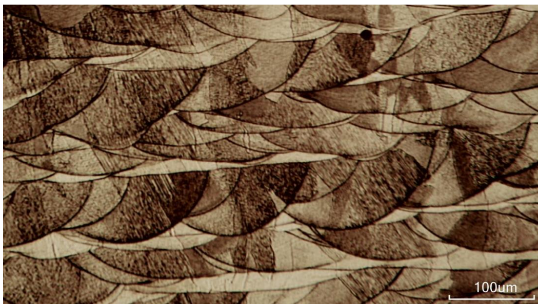
Figura 14: Microscopia óptica do aço 316 L fabricado por MA, com potência do feixe de laser de 184W, em uma escala de 100 \mu\text{m} . Fonte: Autor.
