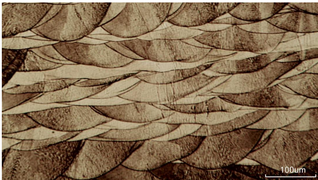
Figura 13: Microscopia óptica do aço 316 L fabricado por MA, com potência do feixe de laser de 184W, em uma escala de 100 \mu\text{m} . Fonte: Autor.
