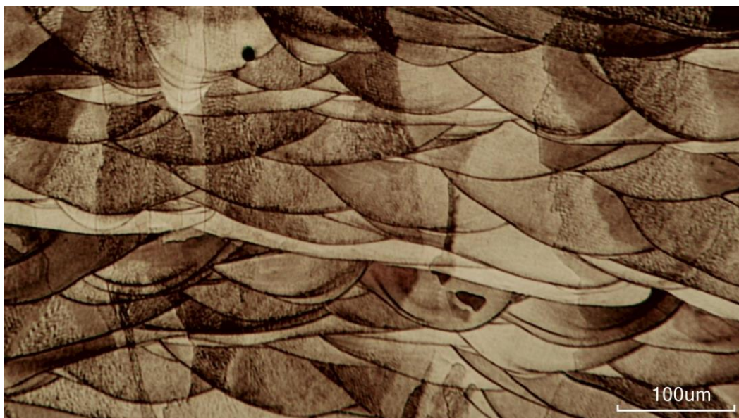
Figura 19: Microscopia óptica do aço 316 L fabricado por MA, com potência do feixe de laser de 211W, em uma escala de 100 \mu\text{m} . Fonte: Autor.
