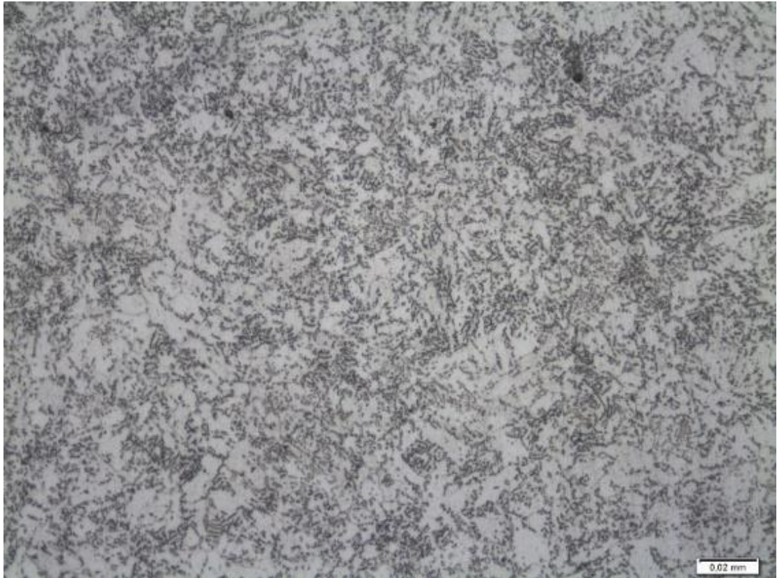
Figura 16: Amostra 2, Bloco, 90% Esferoidizado, 159HB.
