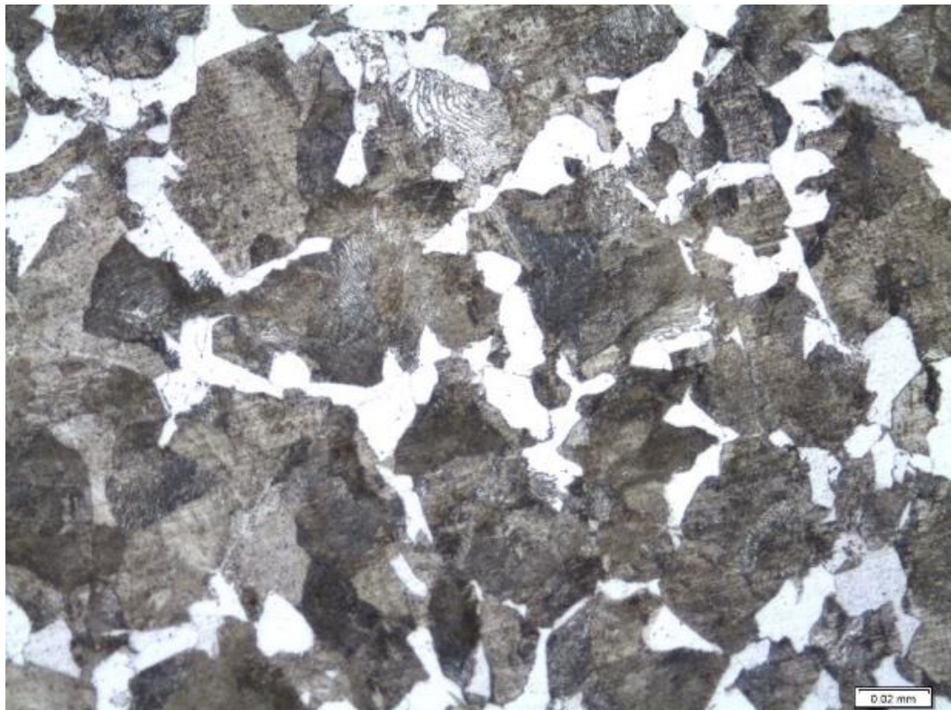
Figura 13: Amostra 3, G, 77% de Perlita e 23% de Ferrita, 321HB
