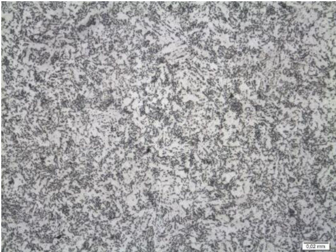
Figura 18: Amostra 4, G, 80% Esferoidizado, 170 HB.
