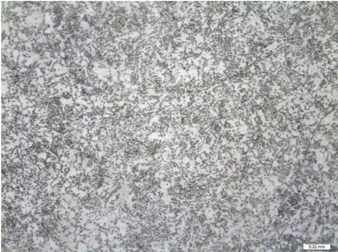
Figura 15: Amostra 1, Bloco, 80% Esferoidizado, 163HB.
