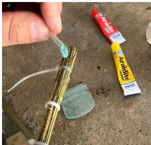
Figura 48 - Aplicação da cola Araldite
