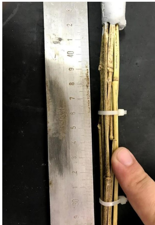
Figura 47 - Rompimento do primeiro colmo de bambu na parte superior do feixe
