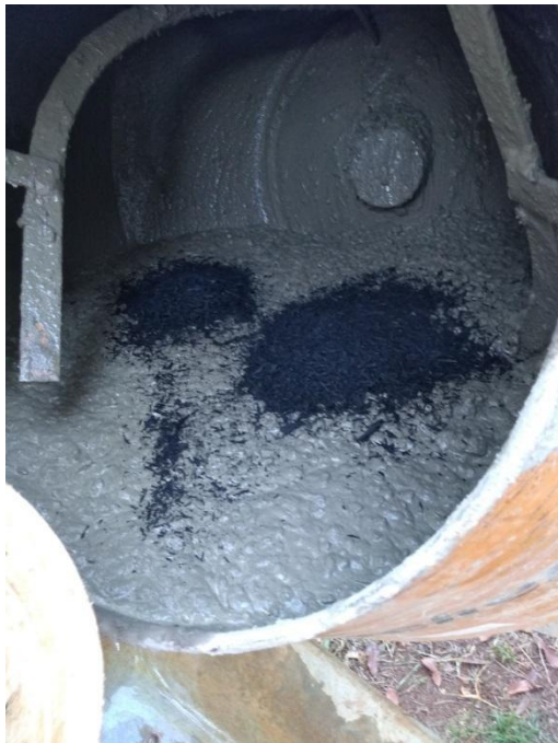
Figura 87- inserção do resíduo de borracha de pneu na massa de concreto
