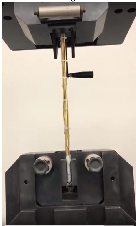
Figura 46 – Feixe de bambus na prensa hidráulica com a ponta esmagada
