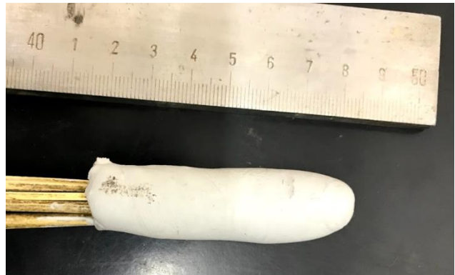
Figura 45 - Proteção das extremidades dos colmos com Durepox
