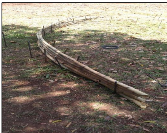
Fonte: elaboração do próprio autor Figura 73 - colmos nas fôrmas durante o período de secagem
