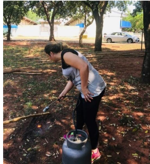
Figura 76- tratamento através do fogo
