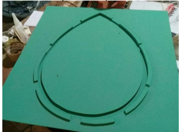
Figura 41 - Fôrma para secagem arqueada da pétala
