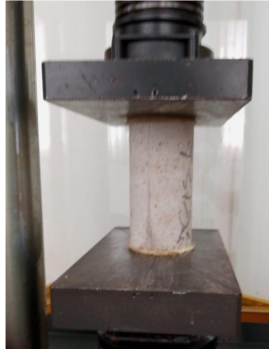
Figura 90- Ensaio de Compressão axial no CP de concreto com adição de resíduo de borracha de pneu.
