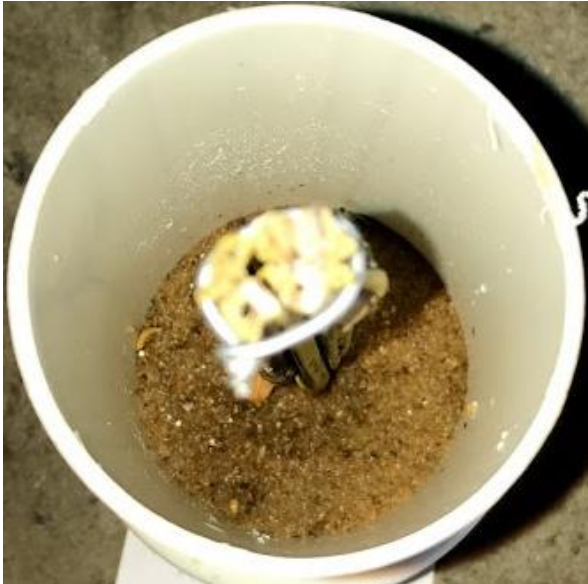
Figura 52- Preparo do CP com o feixe de colmos centralizado
