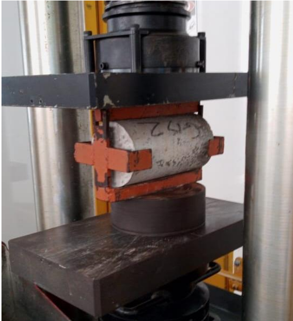
Figura 89- Ensaio de Compressão diametral no CP de concreto com adição de borracha de pneu.
