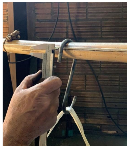
Figura 80: verificação do deslocamento
