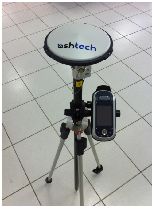
Figura 21- GPS Geodésico L1 - L2 ProMark 200, da marca ASHTECH
