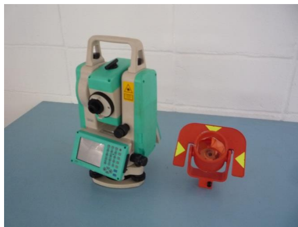
Figura 5 - Estação Total Ruide RTS 862/R e prisma
