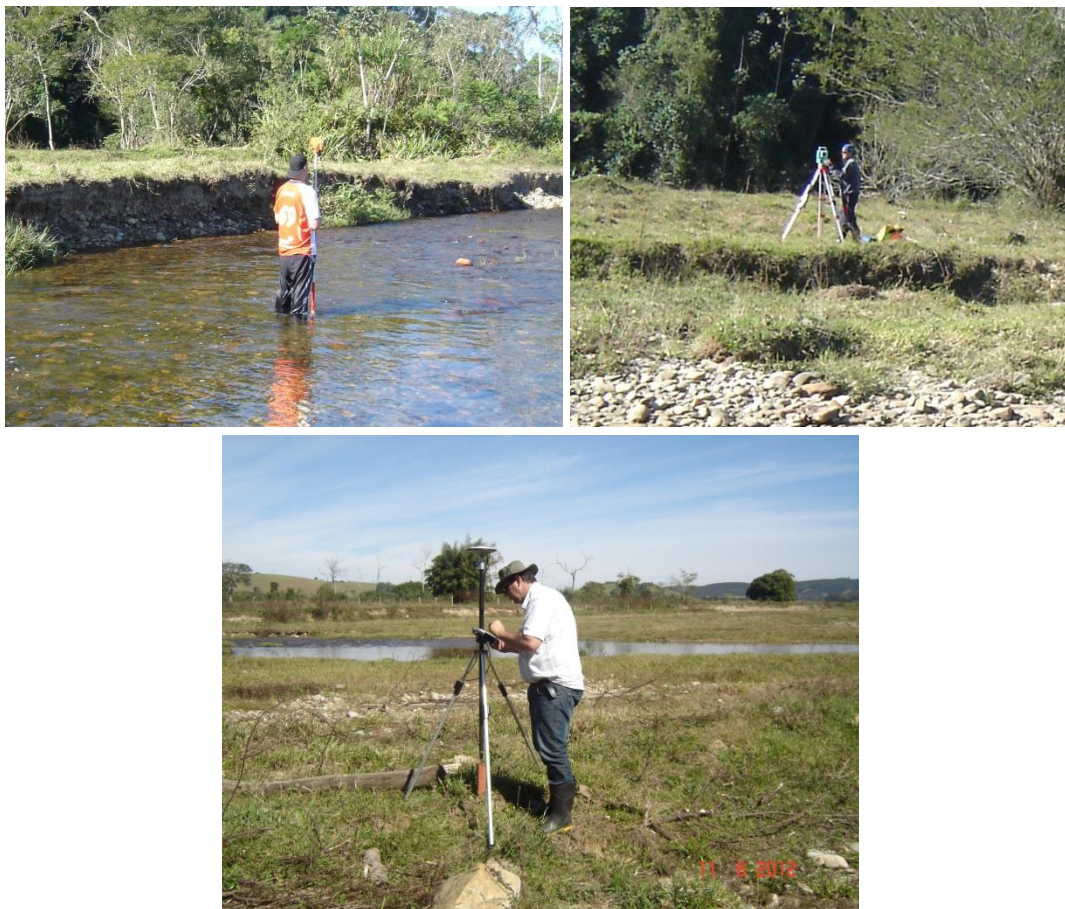
Figura 23 - Levantamento topobatimétrico da área experimental do ribeirão Guaratinguetá, empregando Estação Total e GPS geodésico.
