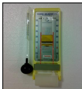
Figura 7. Vista parcial da fixação do globo-termômetro ao termo-higrômetro de leitura direta.
