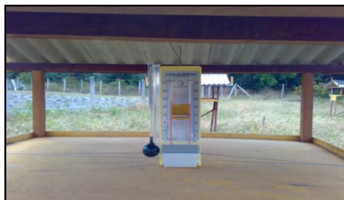
Figura 8. Vista parcial do posicionamento do globo-termômetro e do termo-higrômetro de leitura direta nos modelos reduzidos.
