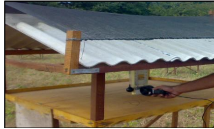
Figura 10. Vista parcial do local de leitura da velocidade do vento.
