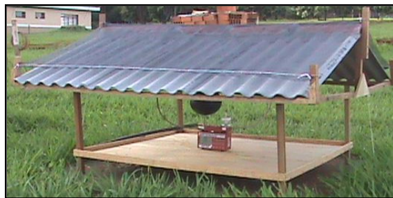
Figura 14. Vista parcial do posicionamento do termômetro de globo digital no interior dos modelos reduzidos no Experimento 2.
