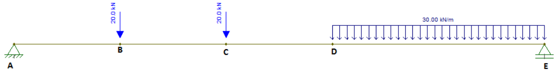
Figura 20 – Marcação dos pontos na estrutura (fonte: autor)
