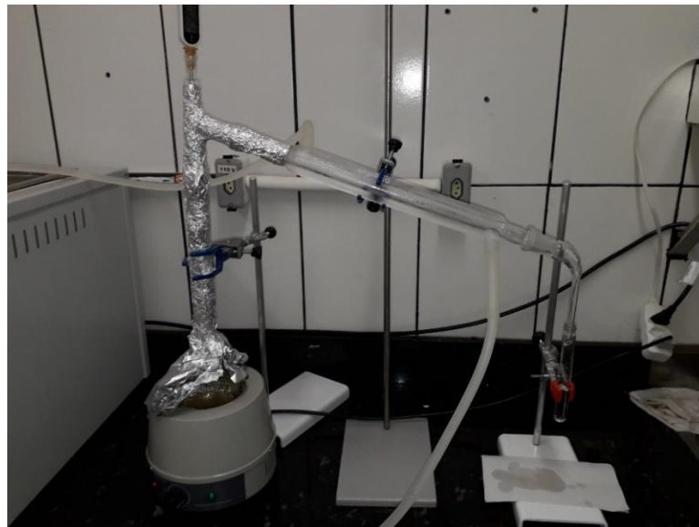
Figura 7. Sistema de destilação atmosférica.
