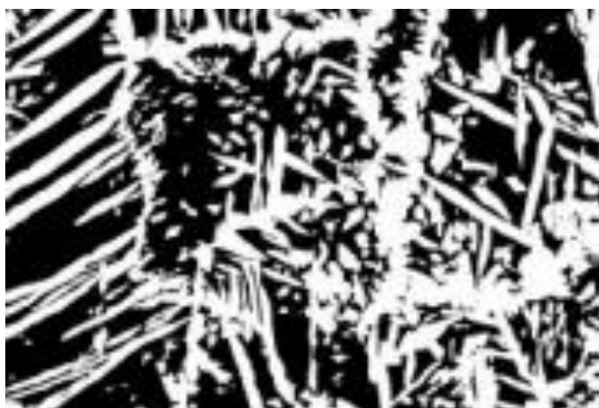
Figura 26 – Fração volumétrica de austenita-ferrita na Amostra 1
