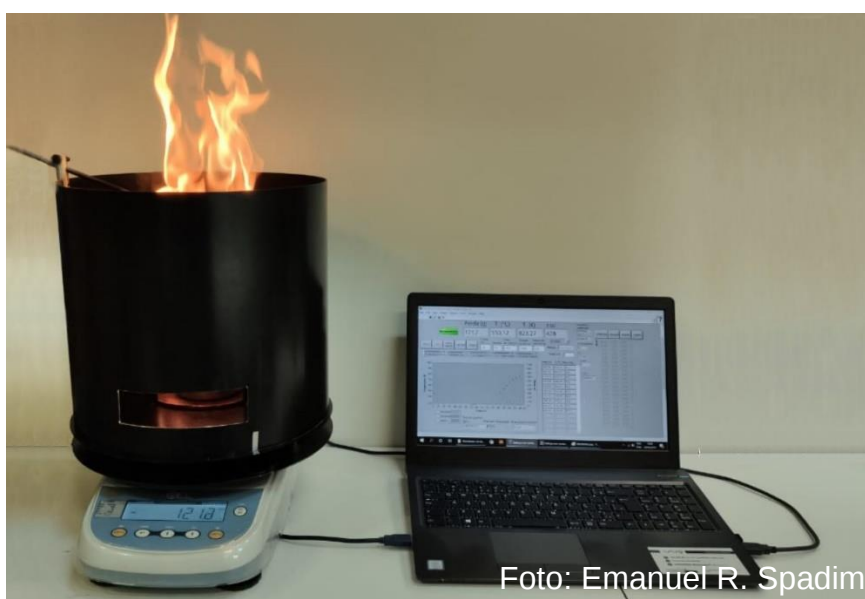
Figura 16 - Queima da biomassa para obtenção do ICOM e ICOMa
