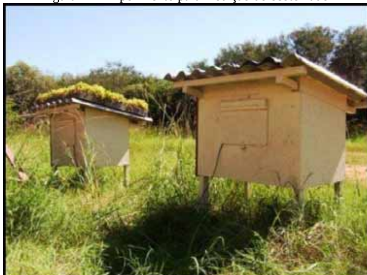
Figura 22 - Experimento para medição do ecotelhado
