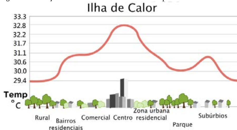
Figura 20- Ilustração da ilha de calor demonstrando a temperatura em diferentes áreas.
