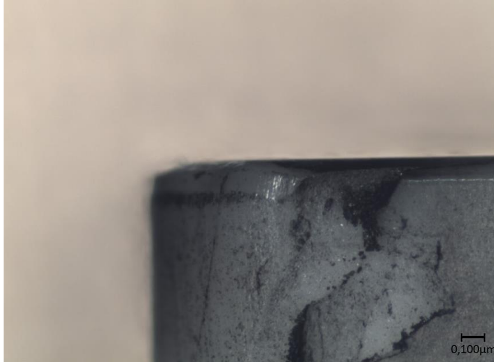
Figura 28 – Lascamento em área de ferramenta cerâmica em ensaio na condição avanço de 0,10mm/rev, velocidade de corte de 450 mm/min e profundidade de corte de 0,75mm.
