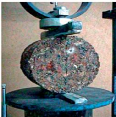
Figura 20 – Ensaio de resistência à tração por compressão diametral
