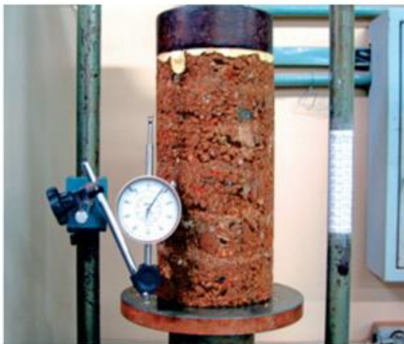
Figura 19 – Ensaio de resistência à compressão simples
