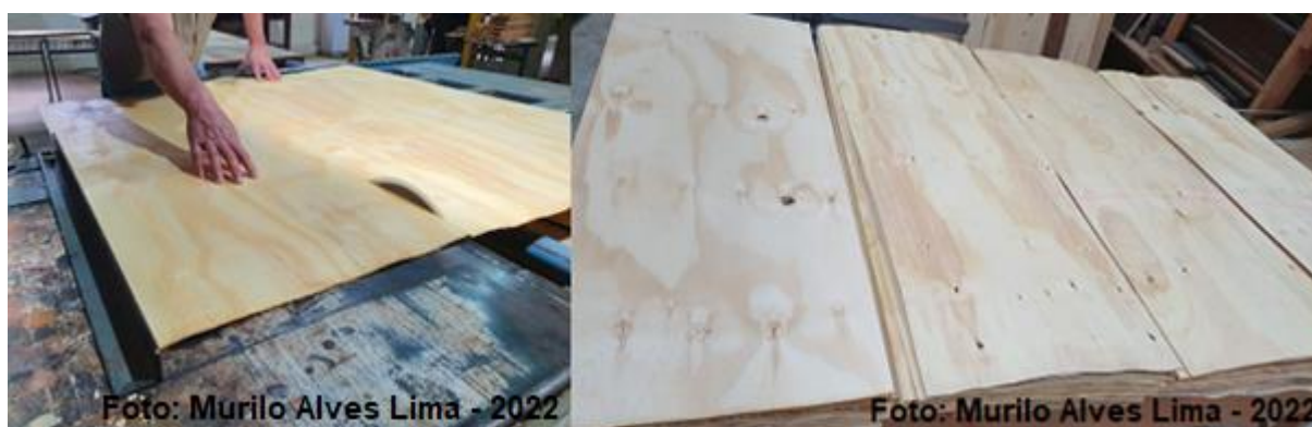
Figura 10 – Serra Circular no Corte de Lâminas de Pinus
