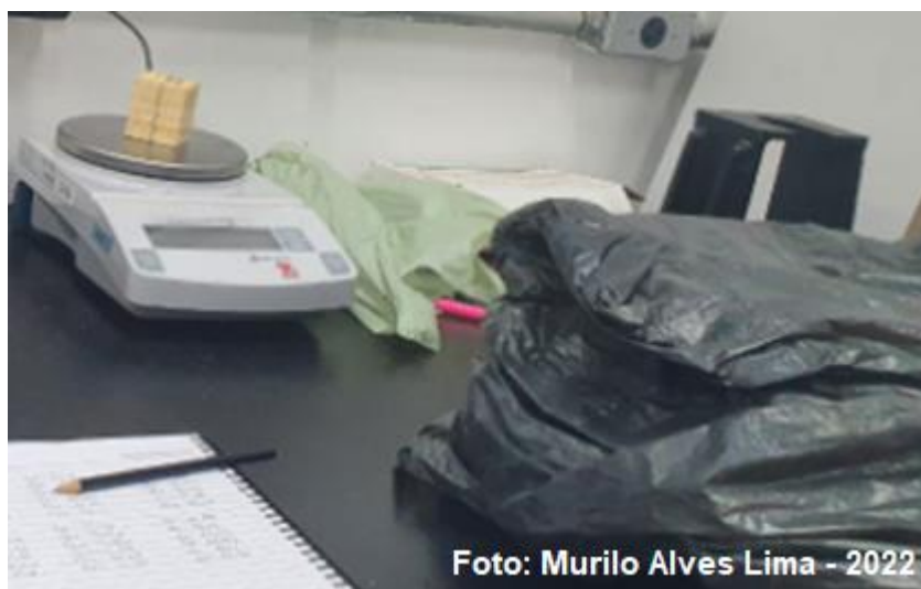
Figura 15 – Método de Determinação do Teor de Umidade e Densidade
