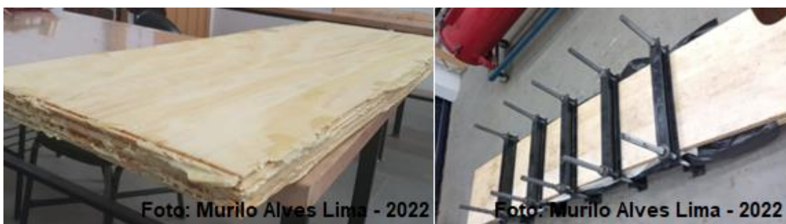
Figura 12 – Sistema de Prensa com Torque
