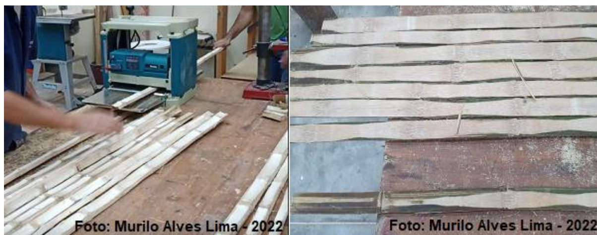
Figura 5 – Usinagem na Plaina Desengrossadeira
