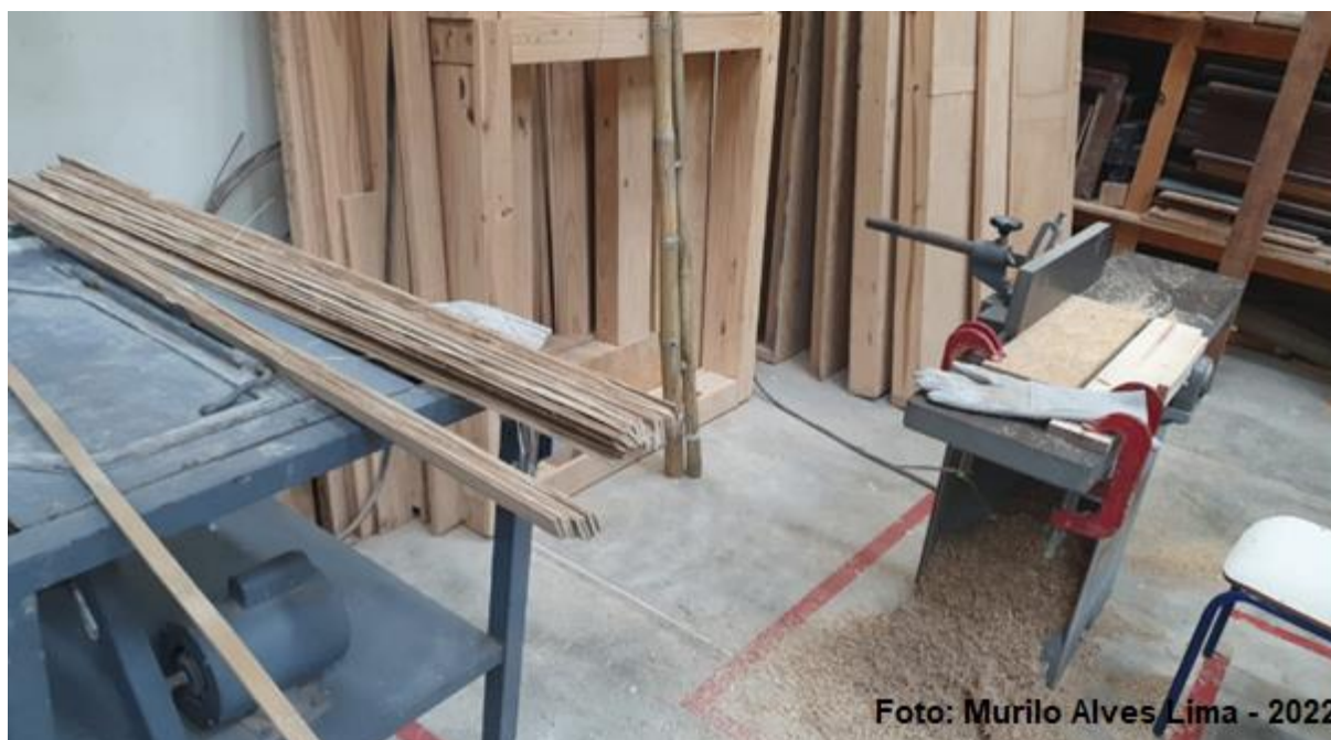
Figura 6 – Usinagem Lateral na Desempenadeira
