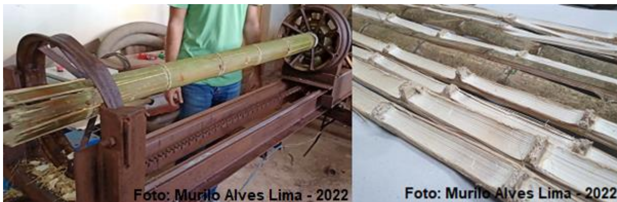
Figura 3 – Rachadora com Faca Radial de 45°
