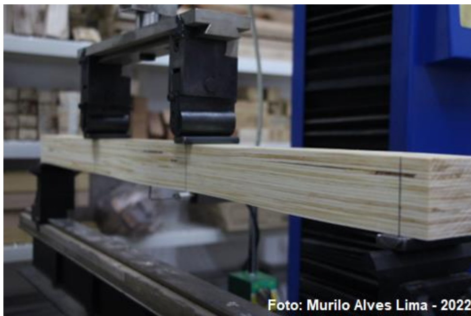
Figura 16 – Ensaio de Flexão Flatwise
