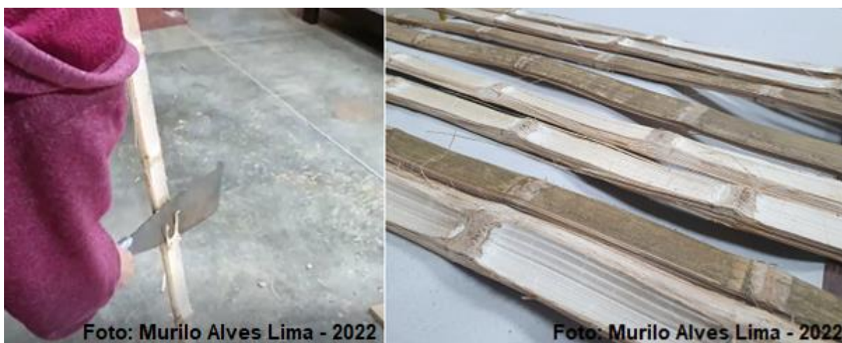
Figura 4 – Usinagem com Facão
