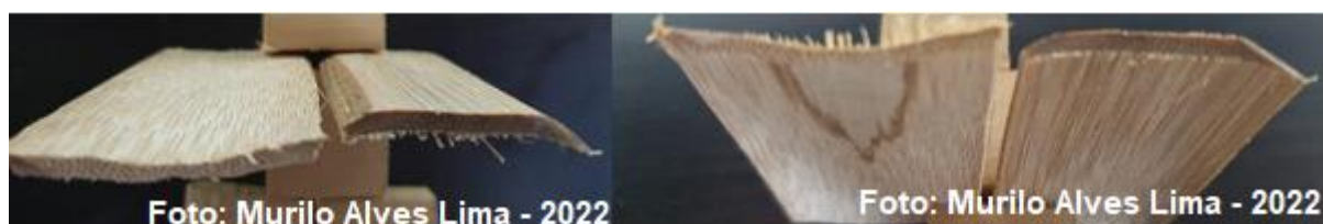
Figura 23 – Encanoamento do Entrenó Central da Peça de Bambu após Usinagem na Plaina Desengrossadeira
