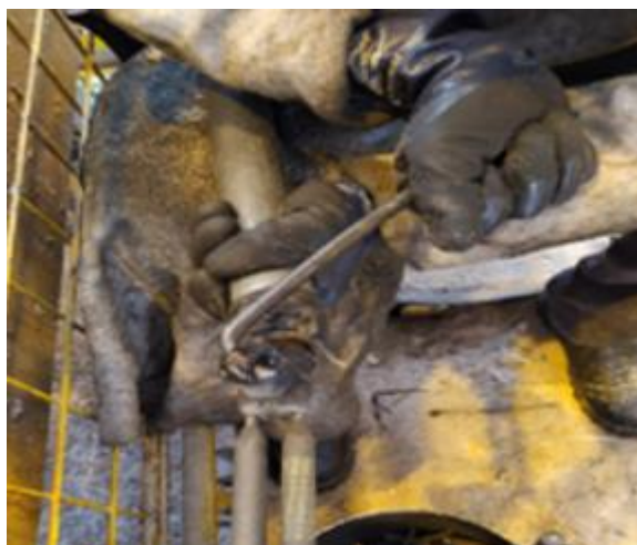
Figura 22 – Uso de vergalhão para apertar eletrodo de chapisco ao alicate de solda
