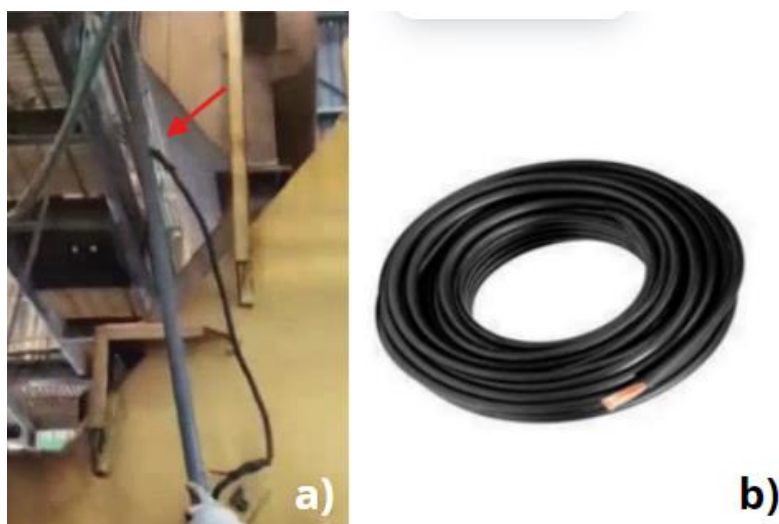
Figura 23 – Cabo positivo sem engate rápido (a) cabo usado no exercício da atividade (b) exemplo do cabo utilizado pela empresa.
