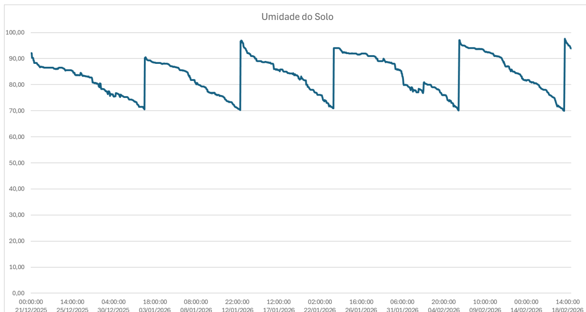
Figura 25 - Medição do percentual de umidade do solo em um período de 60 dias.
