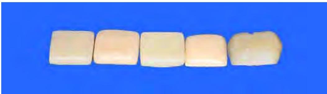
Figura 3 - Barreiras para interposição, seqüência da esquerda para a direita: Resina composta, Cesead; Inceram alumina/AllCeram; IPS Empress; Inceram zirconia/AllCeram; fragmento dental.
